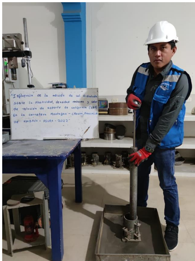
Ensayo Proctor modificado
