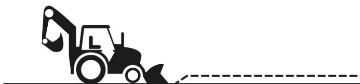
Figura 8 Extendido de material- Mejoramiento de la carretera
