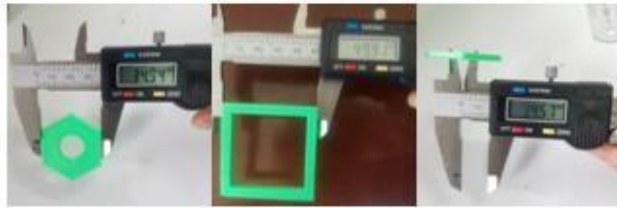
Figura 9: Fotos de mediciones con el instrumento Vernier. Medidas longitudinales (izquierda y centro) y de agujeros (derecha). Fuente: Propia.
