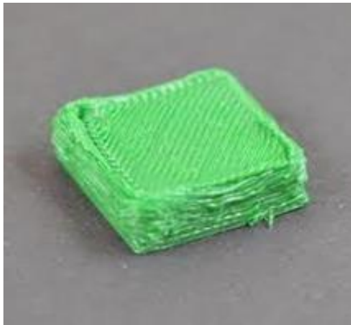
Figura 1: Evidencia de sobre extrusión. Fuente: Propio.
