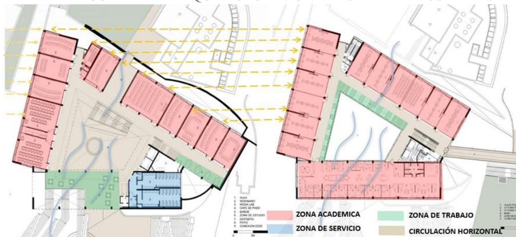
IMAGEN N° 37: ZONIFICACIÓN Y CIRCULACIÓN EN LA PRIMERA Y TERCERA PLANTA FACULTAD DE ARQUITECTURA / UNIVERSIDAD DE LOS ANDES
