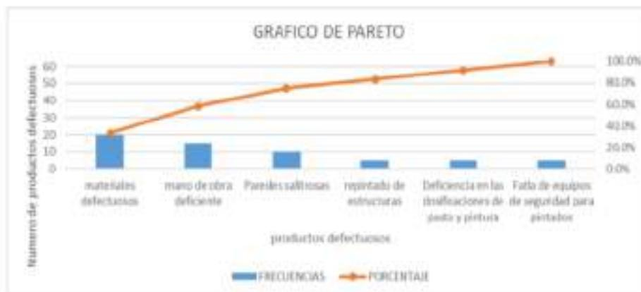
Nota. En la Figura se muestra el control de materiales defectuosos en pintura para Obra Mejoramiento Sistema Alcantarillado, Sector Bombonera, Monserrate, Trujillo. Fuente : Propia de tesis
