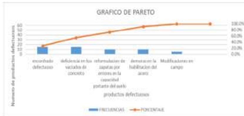
Nota. En el presente diagrama de Pareto podemos determinar los productos defectuosos en concreto de zapatas de la Obra Mejoramiento Sistema Alcantarillado, Sector Bombonera, Monserrate, Trujillo. Fuente Propia de Tesistas.
