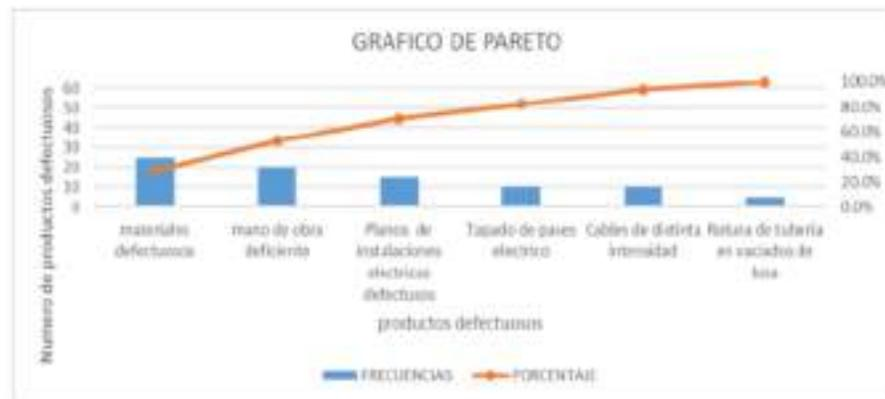
*Nota.* En la figura se muestra la curva de PARETO indicando la frecuencia y porcentaje de material defectuoso cables eléctricos de la Obra Mejoramiento Sistema Alcantarillado, Sector Bombonera, Monserrate. Trujillo. Fuente : Propia de tesistas.
