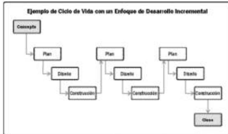
Nota. En la figura se muestra un ejemplo de ciclo de vida de un proyecto con un enfoque Incremental, como lo indica la Guía PMBOK 7ma. Edición. Fuente: PMI (2021).
