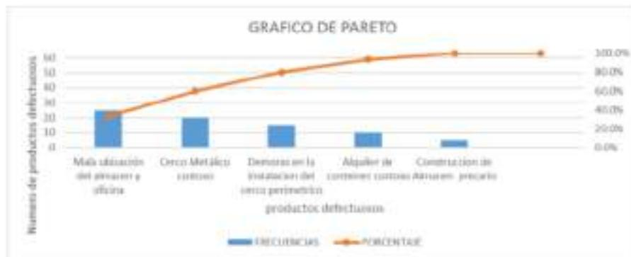
Nota. En la figura se muestra la curva de Pareto en defectos en la habilitación del campamento de Obra Mejoramiento Sistema Alcantarillado, Sector Bombonera, Monserrate, Trujillo. Fuente: Propia de Tesistas,
