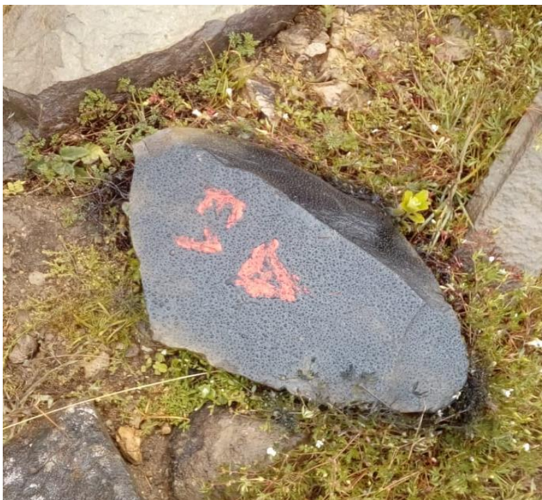
FIGURA N°21: Vista de ubicación de la estación para el levantamiento topográfico.
