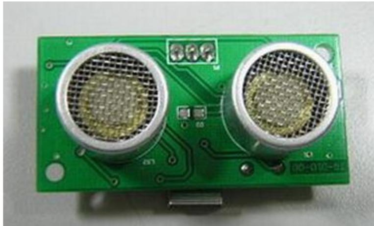
**Fig. 8 Sensor Ultrasónico**
