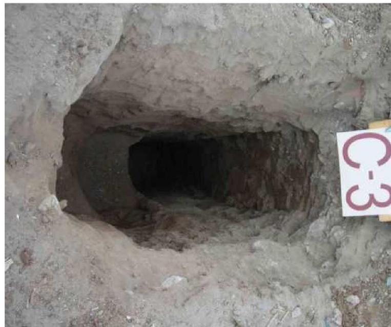
FOTO N° 03: Vista interior de la calicata C-3, donde se muestra el perfil estratigráfico del suelo que alcanzó una profundidad de exploración de 2.00m.
