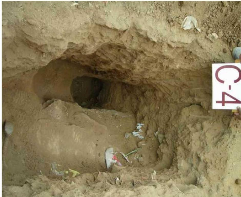
FOTO N° 04: Vista interior de la calicata C-4, donde se muestra el perfil estratigráfico del suelo que alcanzó una profundidad de exploración de 2.00m.
