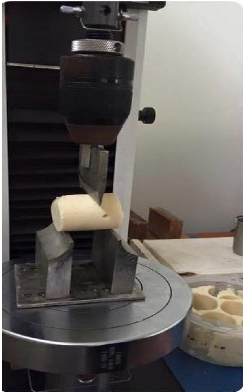
Figura C. Evaluación de la textura en el equipo Texturómetro INSTRON
