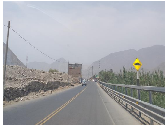
Figura 4: Señal vertical de giba visible y en horizontal no se visualiza, ya que se encuentra sin demarcación.
