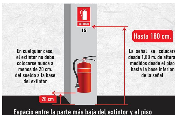
Figura 63: Instalación de un extintor
