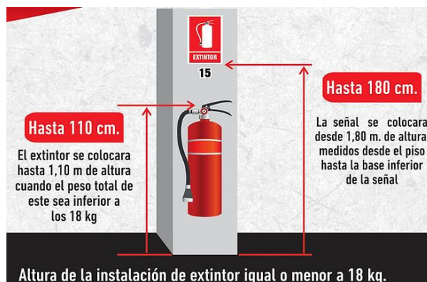
Figura 62: Altura de la instalación de extintor
