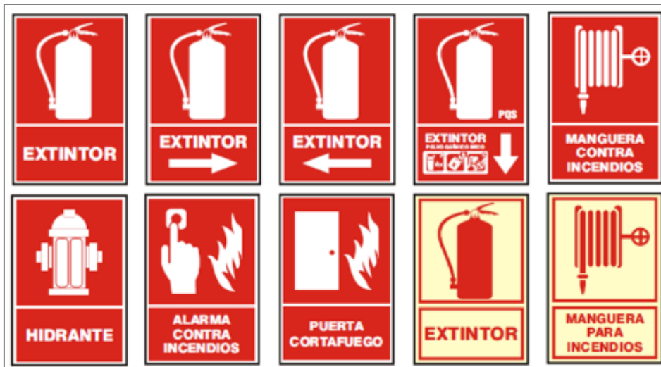
Figura 70 Señalización de equipos de prevención y protección contra incendios.
