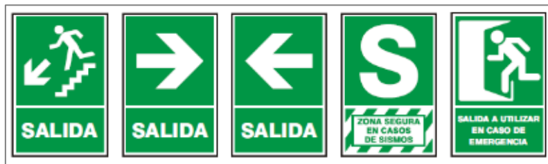
Figura 67 Señalización para evacuación.
