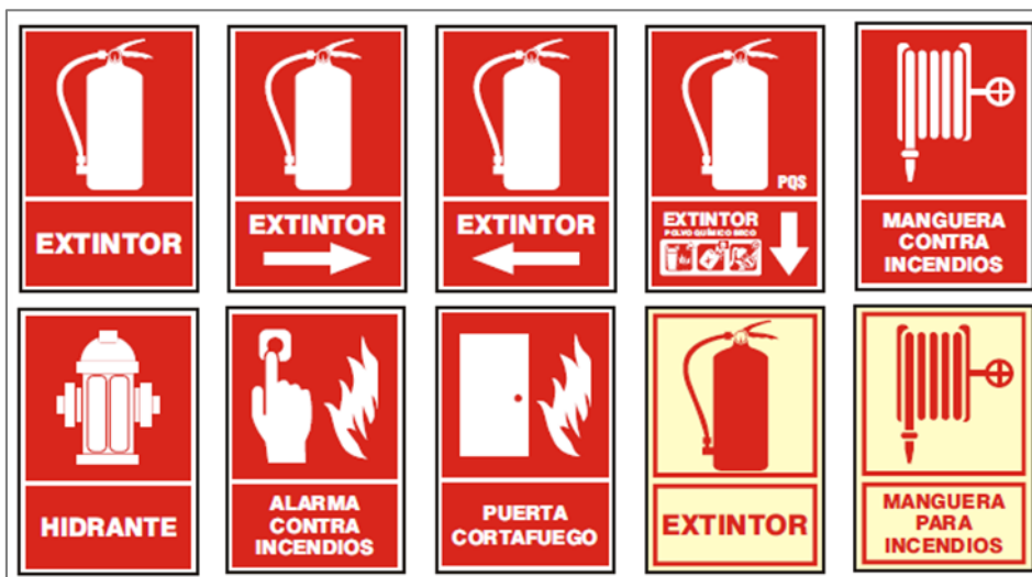
Figura 112 Señalización de equipos de prevención y protección contra incendios.
