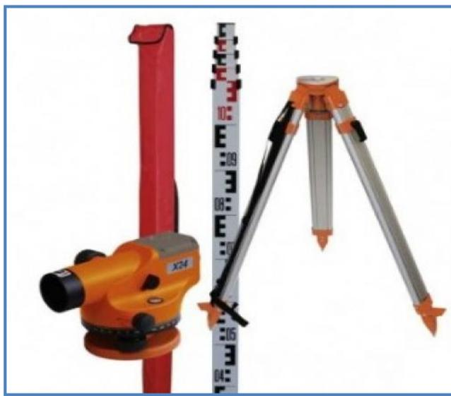
**Ilustración N° 8. Levantamiento con Nivel y mira**
