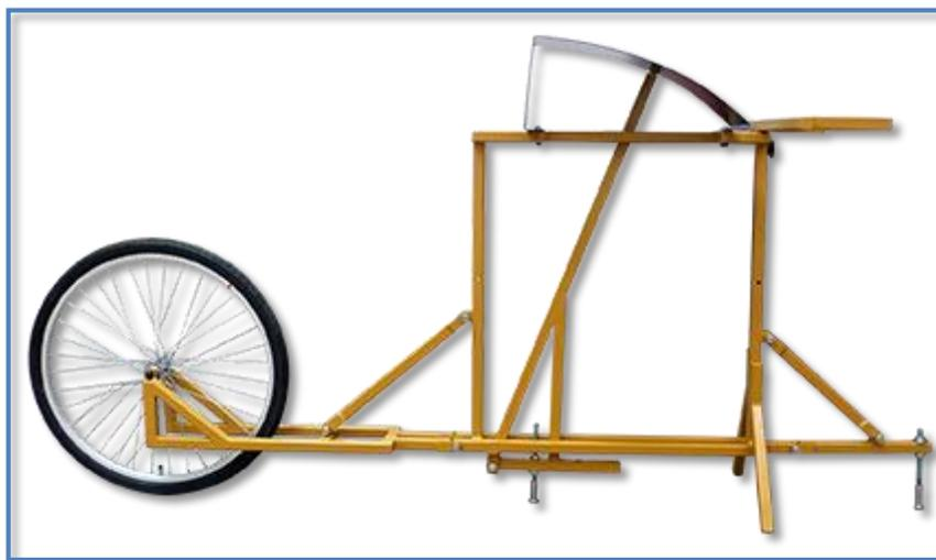
**Ilustración N° 10. Rugosímetro Merlin**
