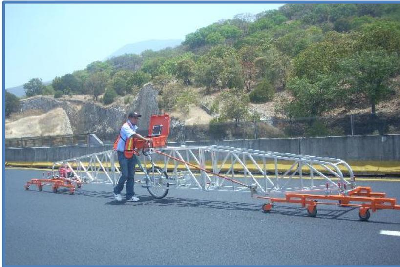
**Ilustración N° 5. Perfilógrafo California**
