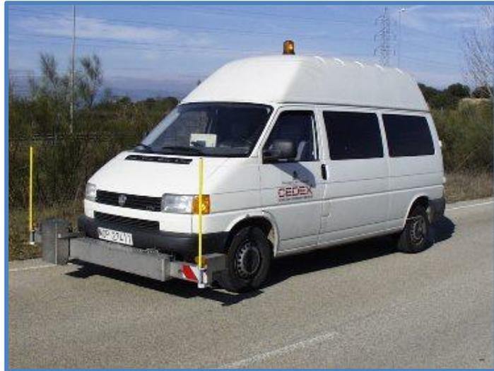
**ILUSTRACIÓN 7. PERFILÓMETRO LÁSER.**
