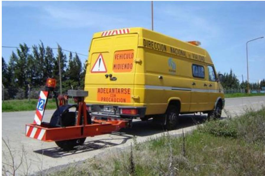
**Ilustración N° 6: El Analizador de Perfiles Longitudinales (APL)**
