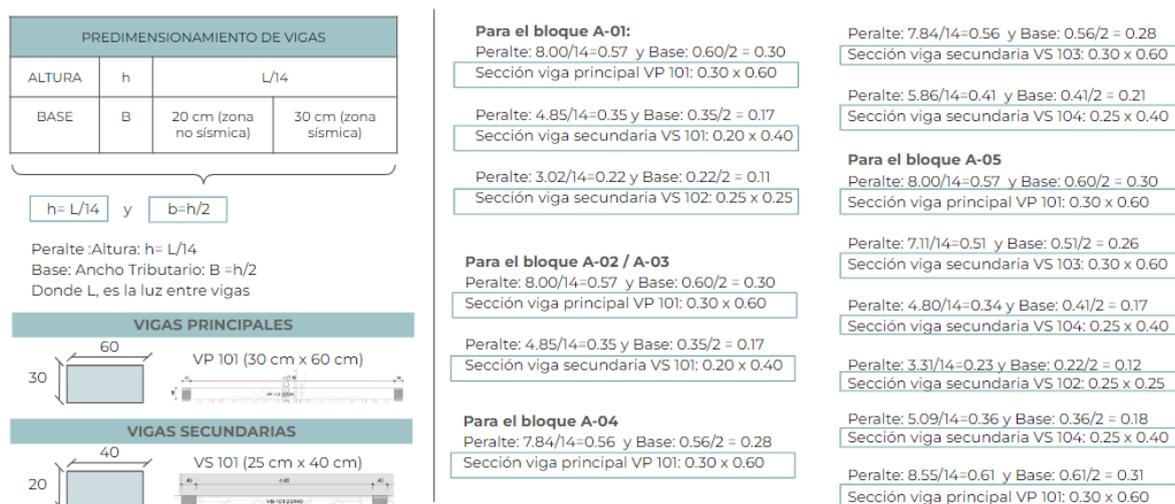
Figura 67: Cálculo predimensionamiento de vigas
