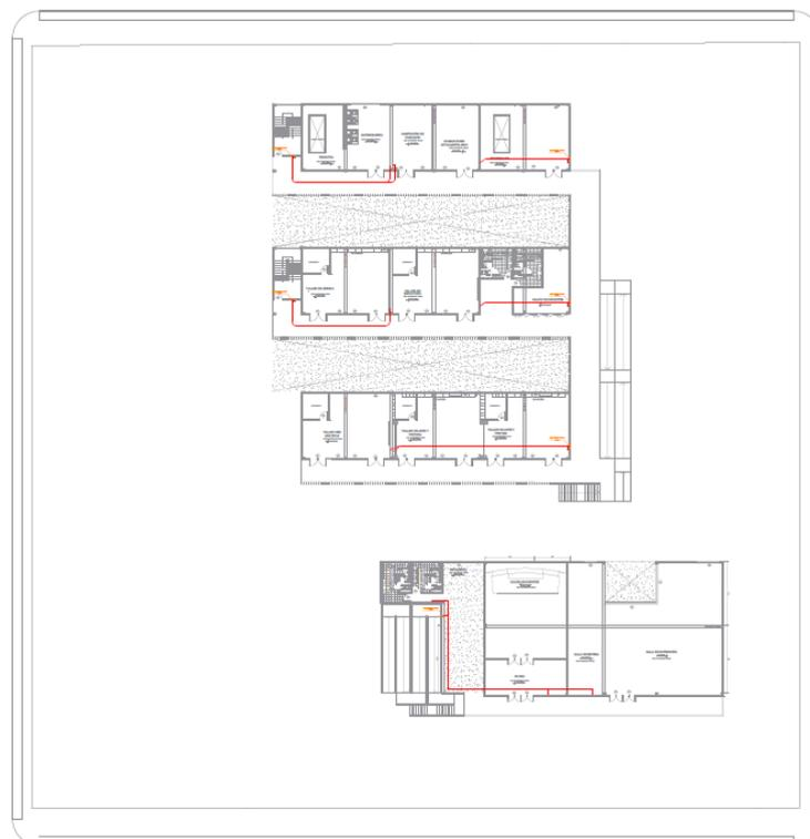
Figura 104: Instalaciones Eléctricas- Tableros generales- 2do nivel
