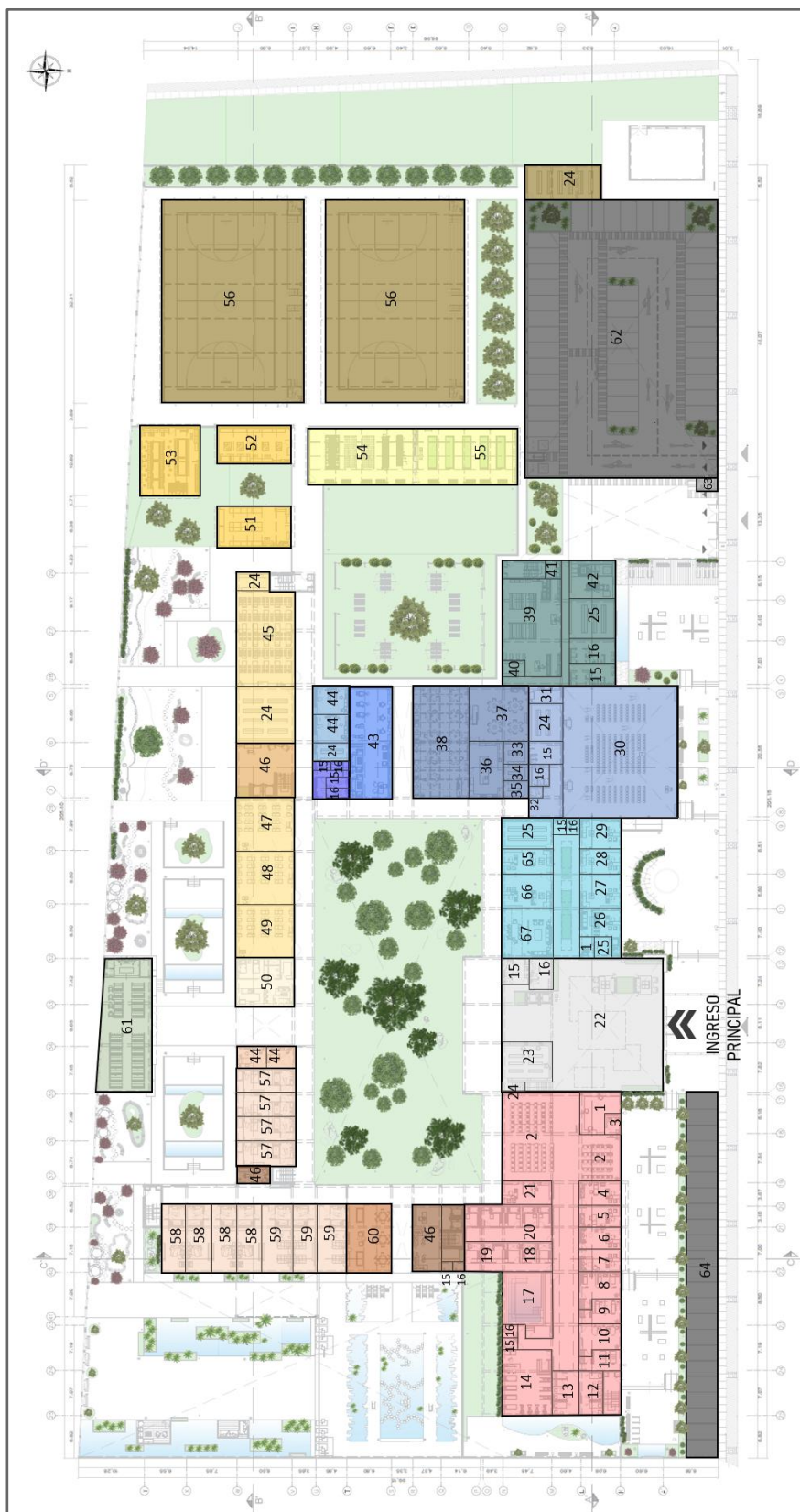
Figura N° 60: Plano de Distribución del Centro de Atención Residencial Gerontológico en Moche- Primer Nivel
