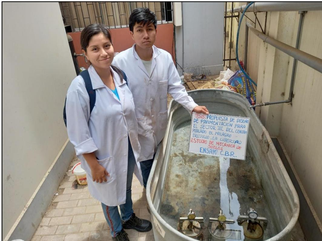
**Fotografía 49:** Estudio de Suelos – Ensayo de CBR – Saturación de muestra de moldes de CBR con su respectivo dial durante 4 días.
