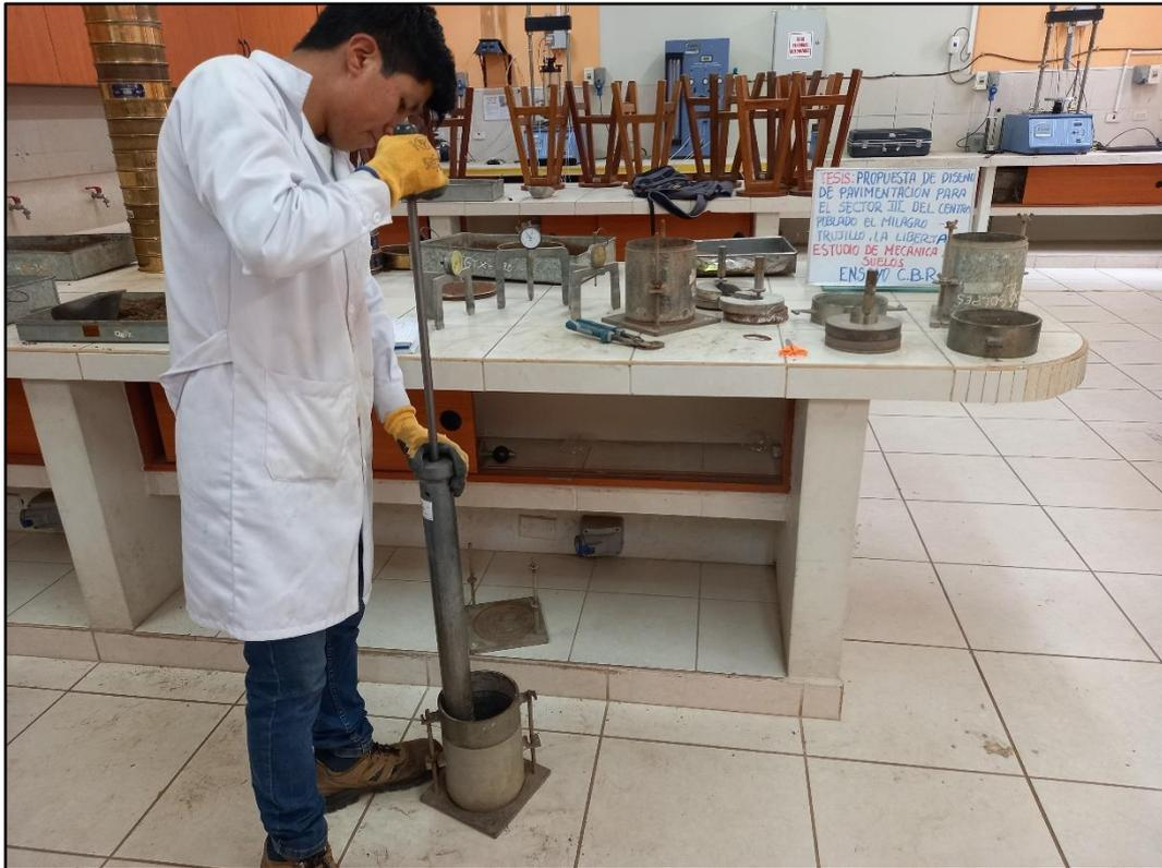
**Fotografía 47:** Estudio de Suelos – Ensayo de CBR – Compactación de la muestra en 5 capas a 56, 25 y 10 golpes por cada molde.
