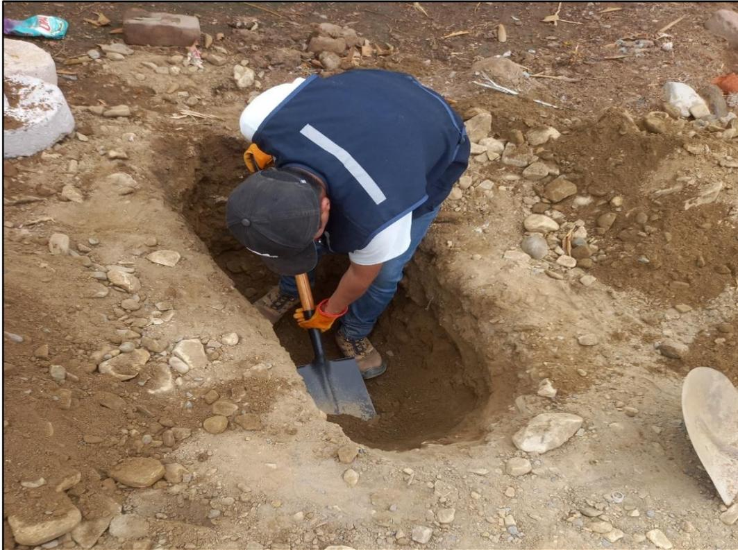
**Fotografía 19:** Estudio de Suelos – Excavación de calicatas
