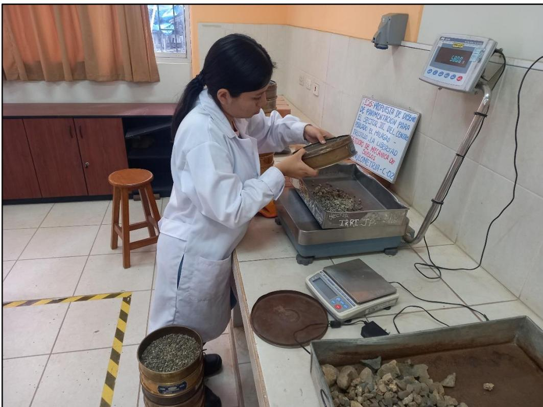
**Fotografía 38:** Estudio de Suelos – Ensayo de Granulometría – Toma de los pesos retenidos en cada tamiz.
