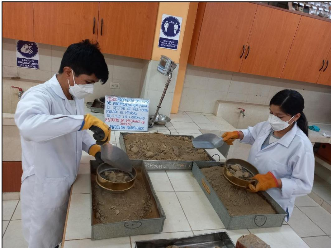
**Fotografía 43:** Estudio de Suelos – Ensayo de Proctor modificado – Tamizado por la malla  $\frac{3}{4}$ ” para la toma de muestra a ensayar.
