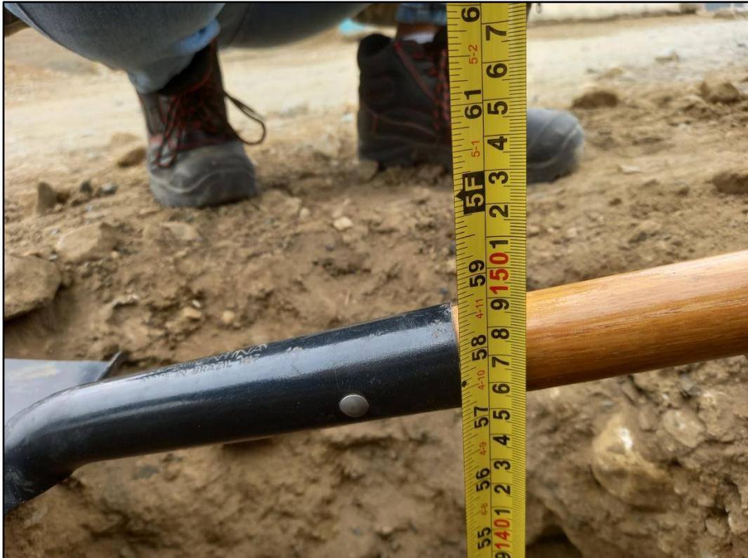
**Fotografía 21:** Estudio de Suelos – Medición de profundidad de 1.5 m de calicata
