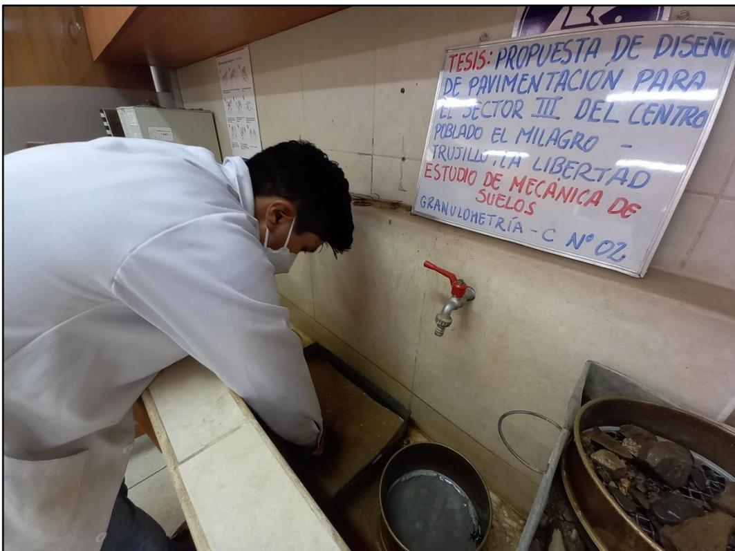
**Fotografía 36:** Estudio de Suelos – Ensayo de Granulometría – Lavado de muestra para eliminar el material fino.
