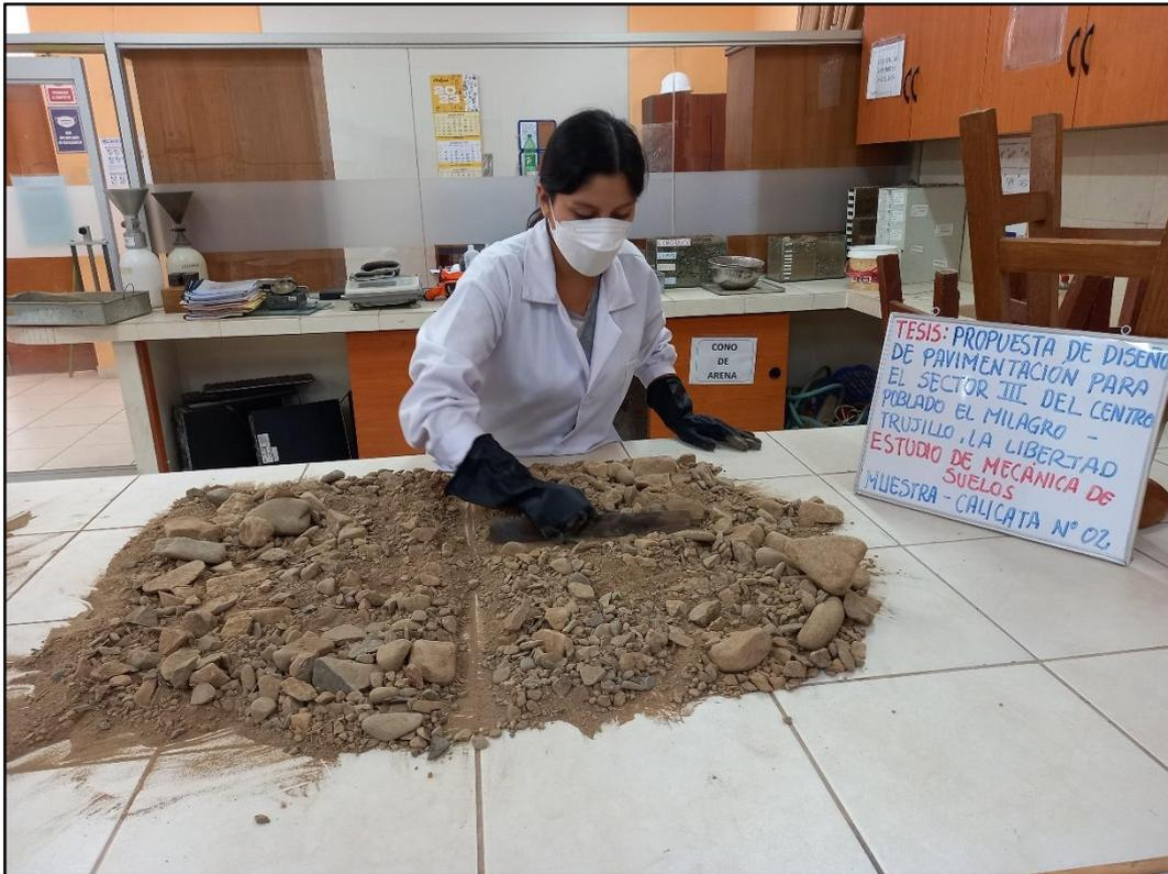
**Fotografía 35:** Estudio de Suelos – Ensayo de Granulometría – Cuarteo de la muestra.
