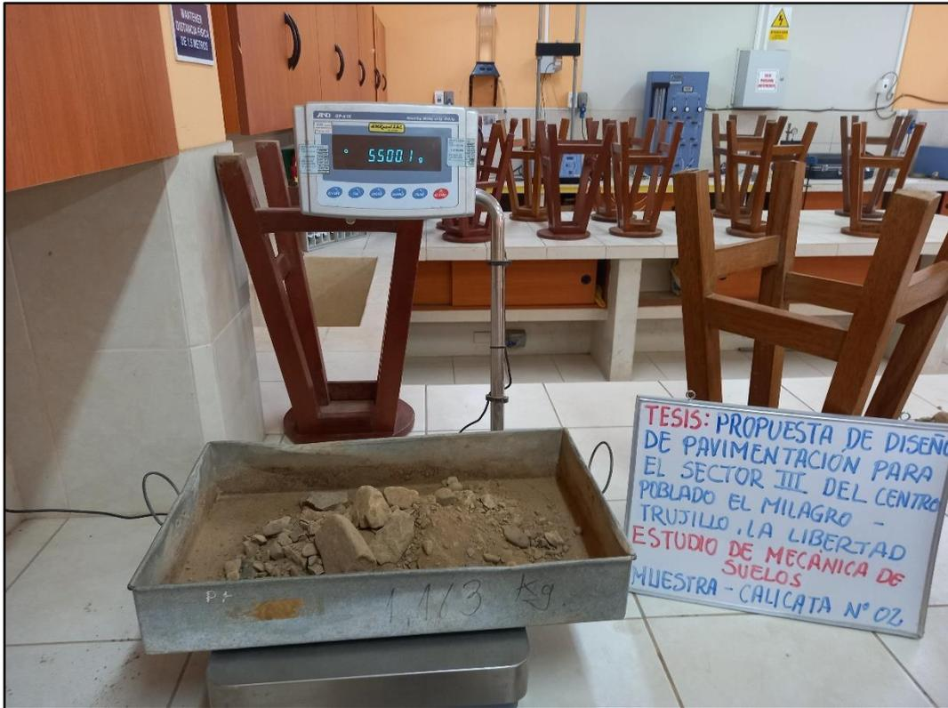
**Fotografía 33:** Estudio de Suelos – Contenido de humedad – Toma del peso de la muestra a ensayar
