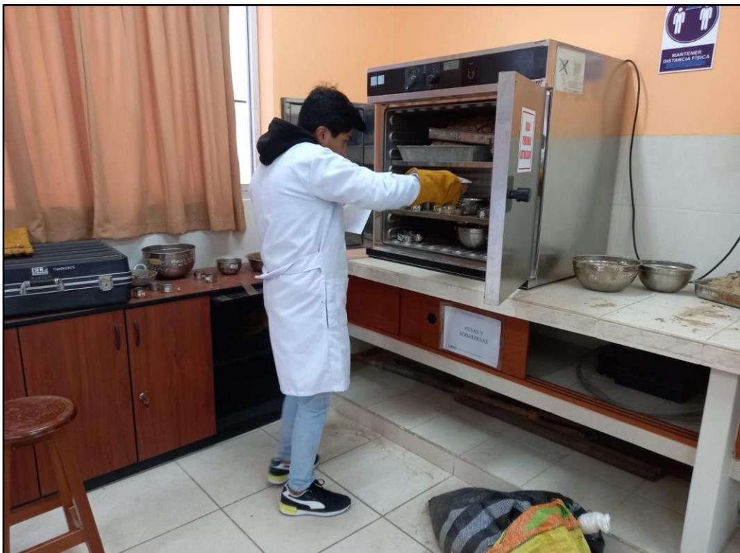
**Fotografía 34:** Estudio de Suelos – Contenido de humedad – Colocación de muestra húmeda al horno.
