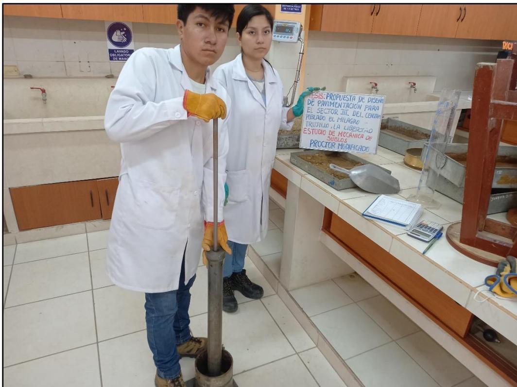
**Fotografía 46:** Estudio de Suelos – Ensayo de Proctor modificado – Compactación de muestra húmeda en 5 capas con 56 golpes cada capa.
