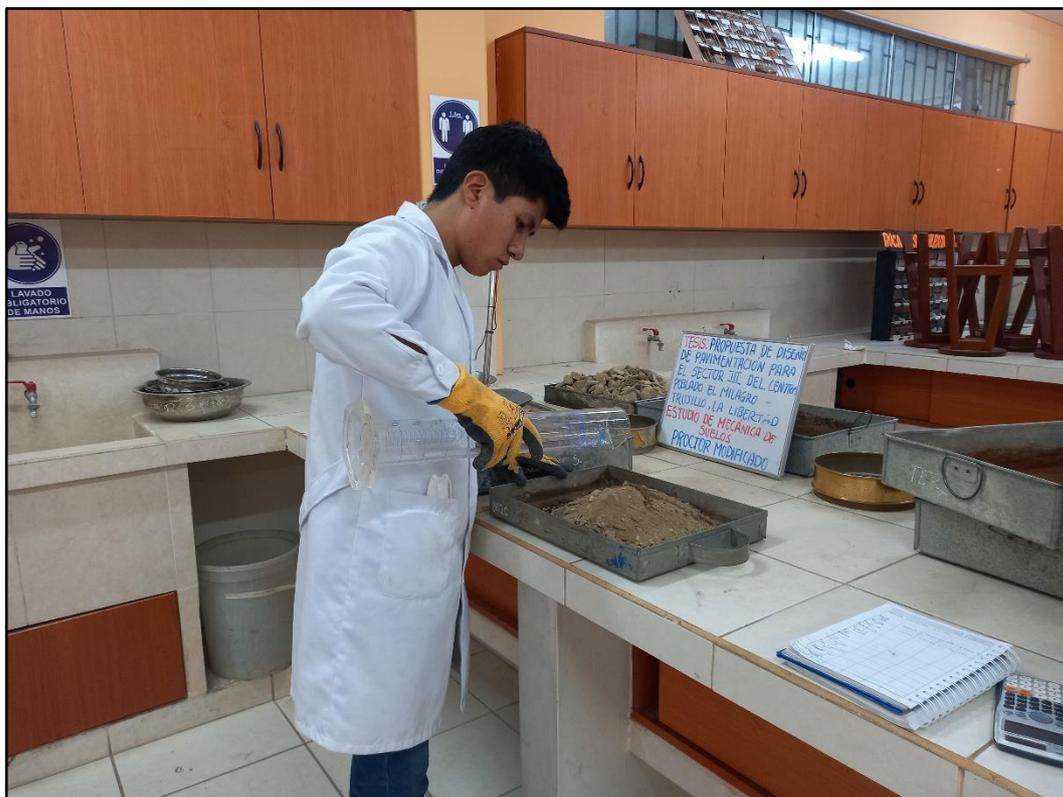
**Fotografía 44:** Estudio de Suelos – Ensayo de Proctor modificado – Humedecimiento de muestra con un porcentaje de agua estimado del 2%, 4%, 6% y 8%.
