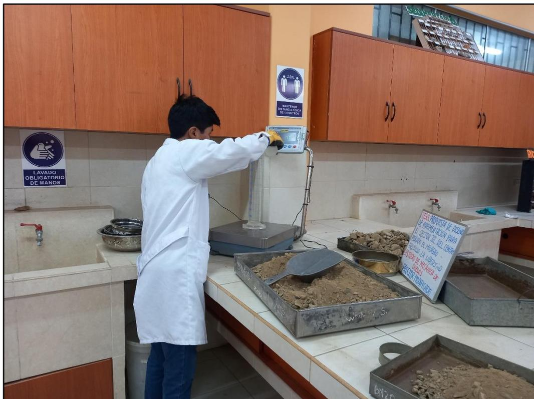
**Fotografía 48:** Estudio de Suelos – Ensayo de CBR – Humedecimiento de muestras para ensayar con su humedad óptima.
