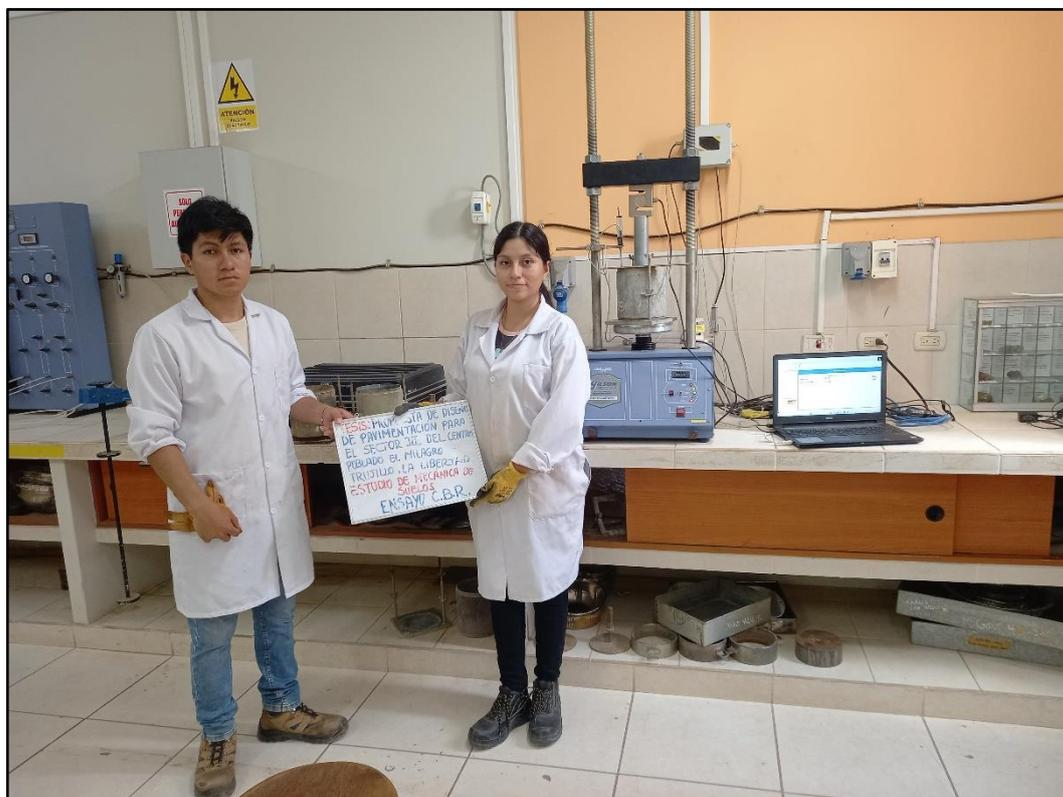
**Fotografía 50:** Estudio de Suelos – Ensayo de CBR – Sometimiento de las muestras a una carga unitaria en Prensa CBR para lograr profundidad de penetración del pistón.
