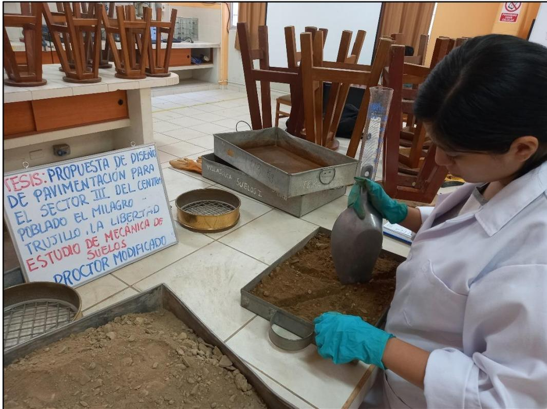
**Fotografía 45:** Estudio de Suelos – Ensayo de Proctor modificado – División de muestra húmeda para compactado por capas.
