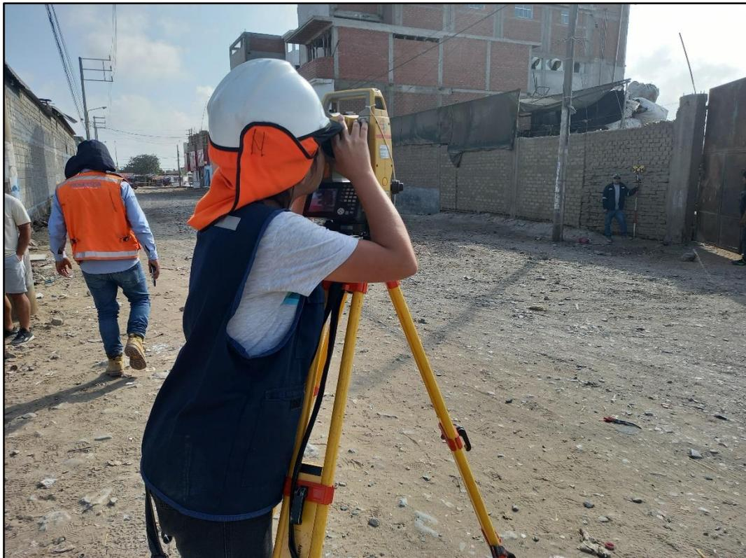
**Fotografía 12:** Levantamiento topográfico de la zona de estudio –
