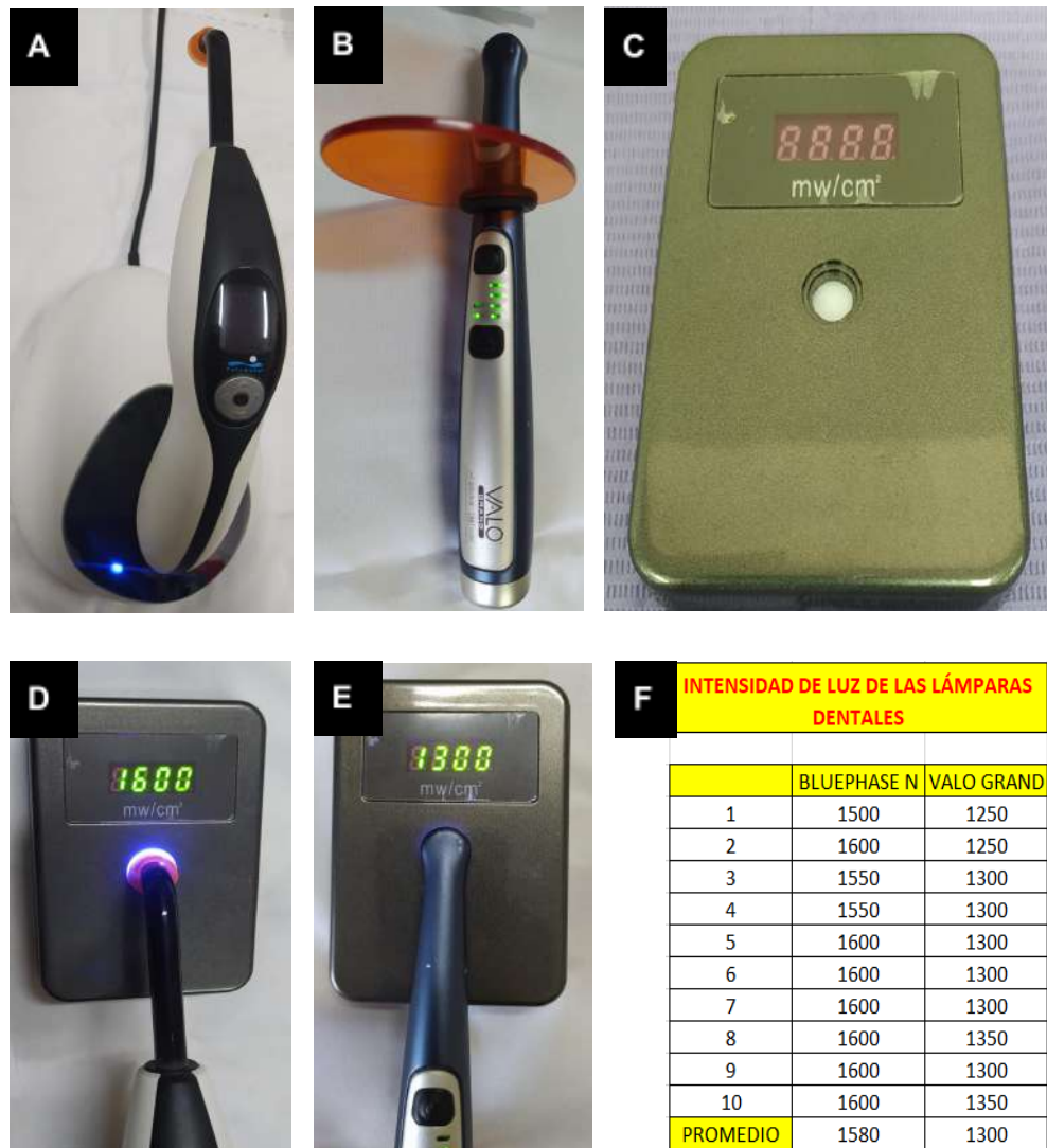
A) Lámpara Bluephase N, B) Lámpara Valo™ Grand, C) Medidor digital (medidor de luz de curado dental con pantalla LED – Shadental), D) Medición de la intensidad de la lámpara Bluephase N, E) Medición de la intensidad de la lámpara Valo™ Grand, F) Valores de las 10 mediciones de cada lámpara y sus respectivos promedios.
