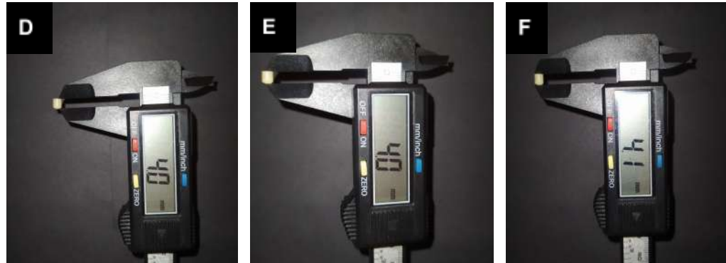
C) Medición de la longitud final de los cilindros de resina en 3 zonas diferentes, empleando el micrómetro digital (Calibrador digital electrónico Vernier – Caliper Black 150, de 0.01 de precisión): D) Zona derecha, E) Zona media, F) Zona izquierda.
