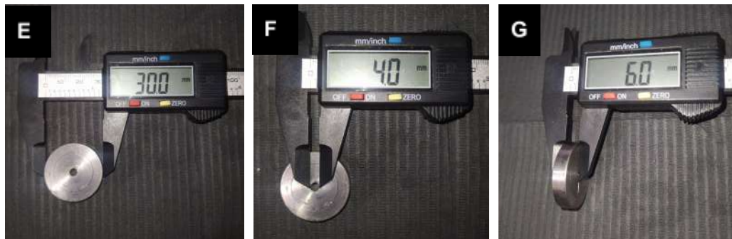
Medidas de los conformadores, empleando un micrómetro (Calibrador digital electrónico Vernier – Caliper Black 150, de 0.01 de precisión): E) Diámetro externo de 30 mm, F) Diámetro interno de 4 mm, G) Altura de 6 mm
