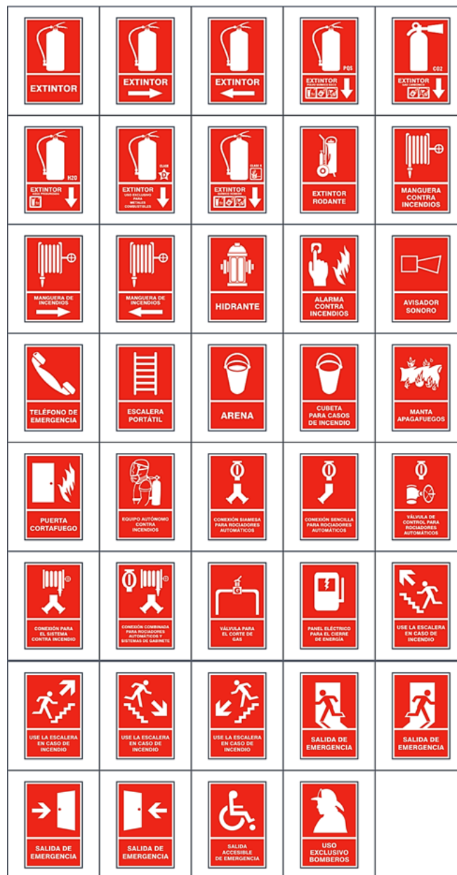
FIGURA N°196: Carteles para Equipos contra Incendios
