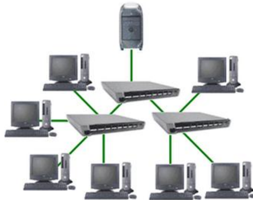
FIGURA N° 189: Esquema de una Topología de Arbol.
