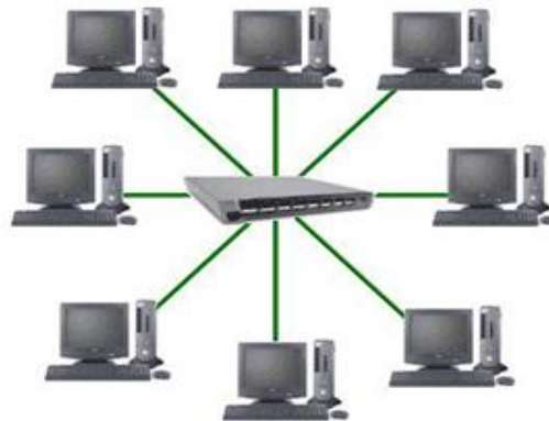
FIGURA N° 187: Esquema de una Topología de Estrella.
