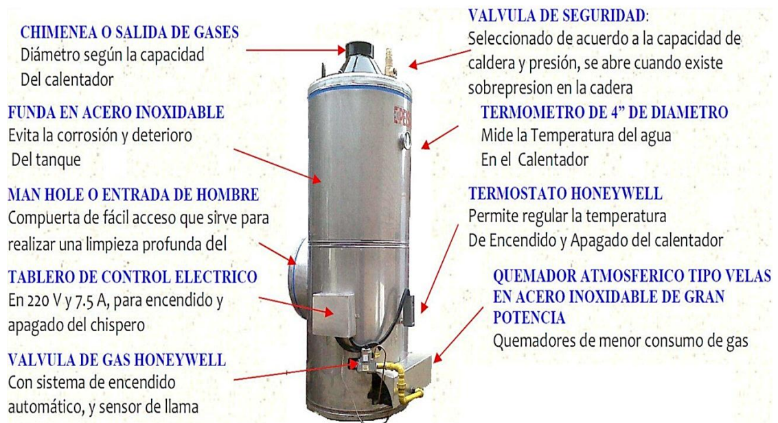
FIGURA N°129: Esquema Termotanque Agua Térmica.
