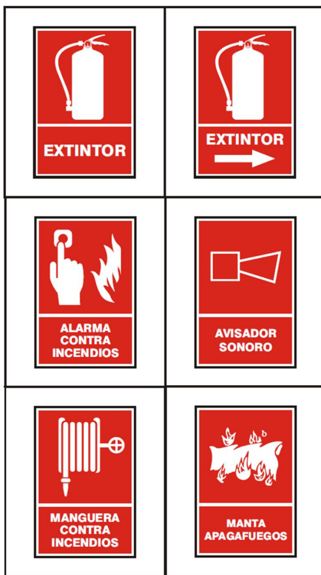
Figura N°13: Carteles de equipos contra incendios
