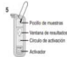
6. En cuanto aparezca color en el círculo de activación, presionar el activador con firmeza hasta que quede al ras con el cuerpo del dispositivo.
