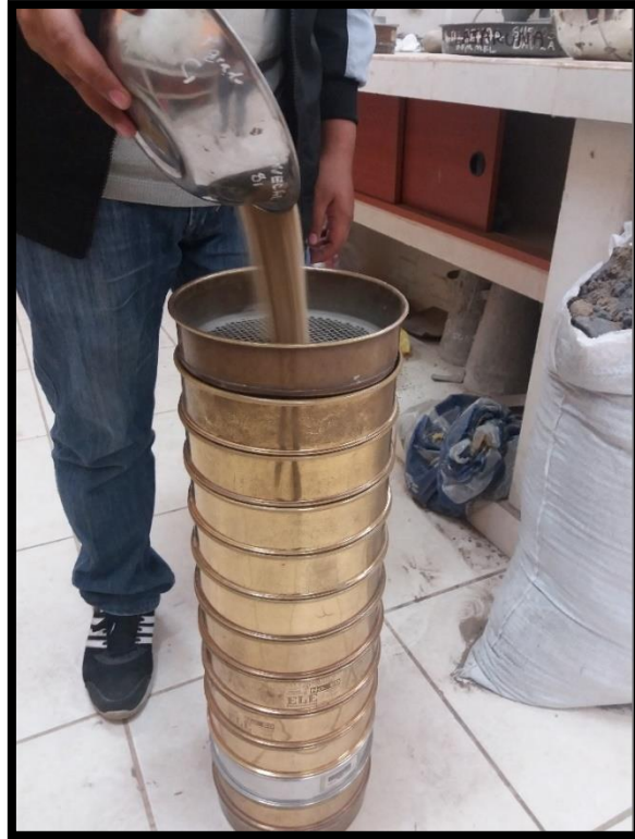
Colocación de muestra y proceso de tamizado (Calle 5)
