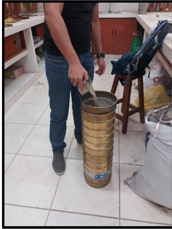
Colocación de muestra y proceso de tamizado (Calle 9)
