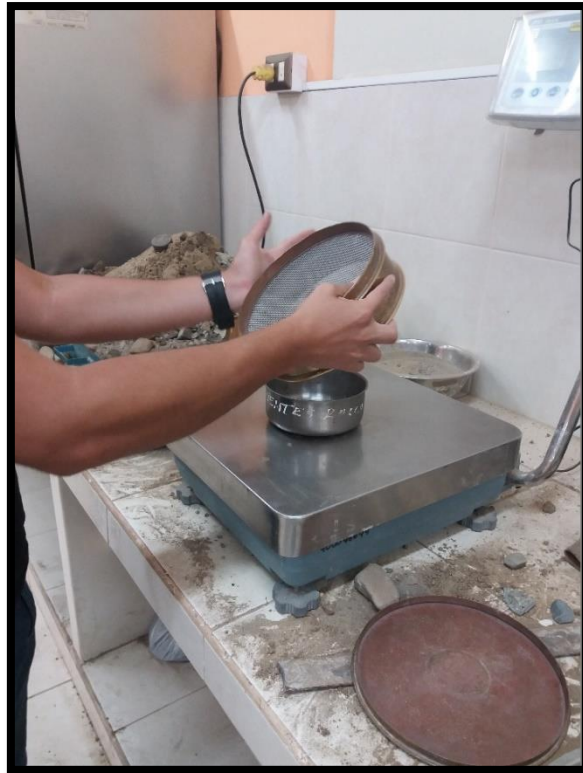
Retiro de muestra retenida en cada tamiz (Calle 9)
