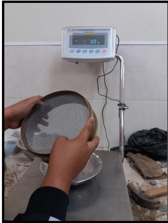
Retiro de muestra retenida en cada tamiz (Calle 5)
