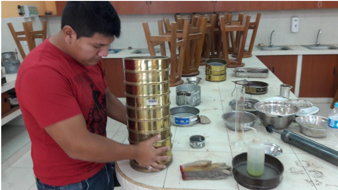
VISTA DE TRABAJOS DE ENSAYO GRANULOMETRICO
