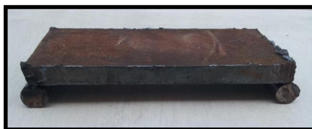
FIGURA 17: Repartidor de Carga L/3
