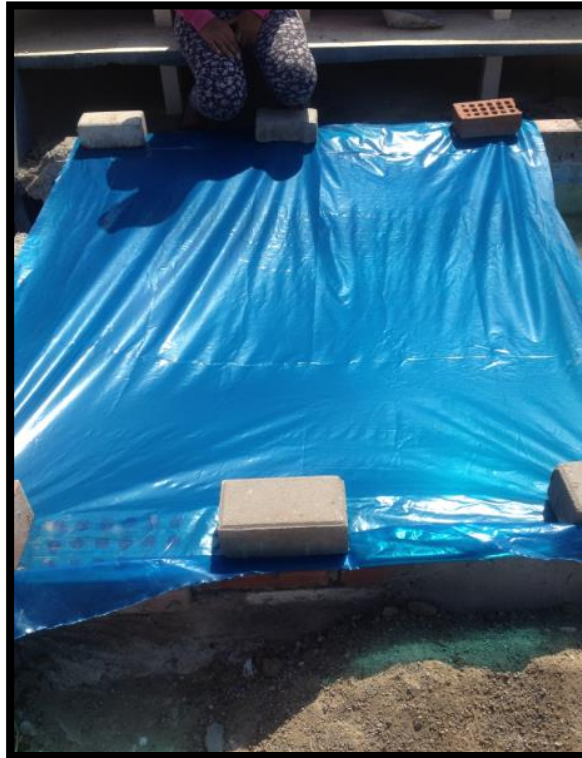
FIGURA 25: Adición de Cal y protección de las probetas prismáticas
