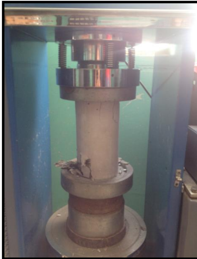
FIGURA 27: Ensayo de Compresión en el Laboratorio Huertas Ingenieros SAC
