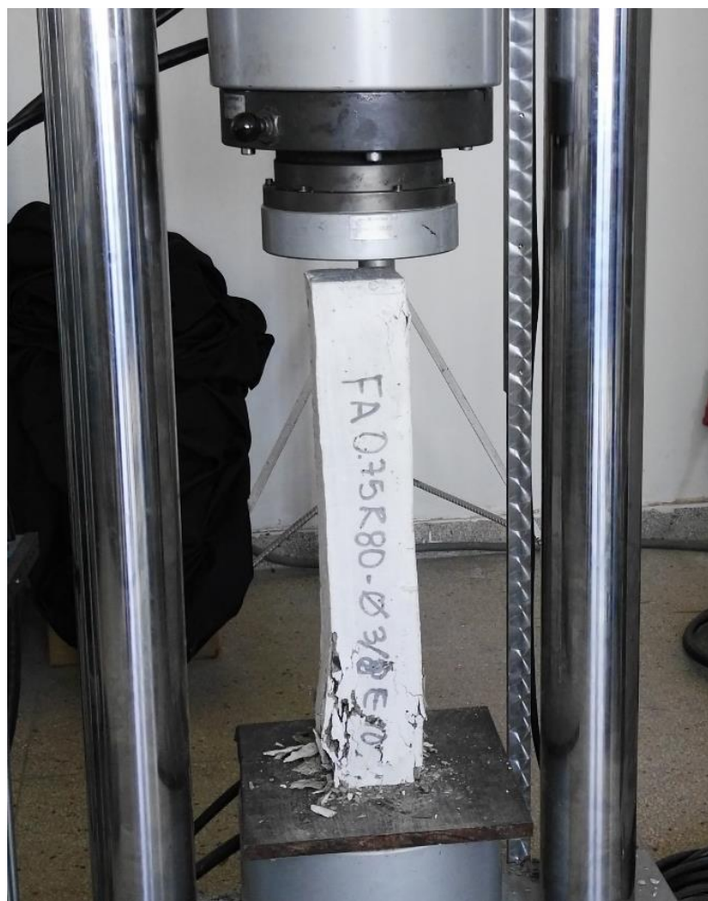
Figura 37.- Muestra FA0.75R100-Ø3/8E10. Fuente: Propia
