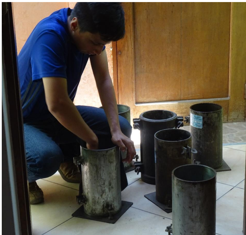
Figura 22.- Molde de para Probetas de Concreto Fuente: Propia
