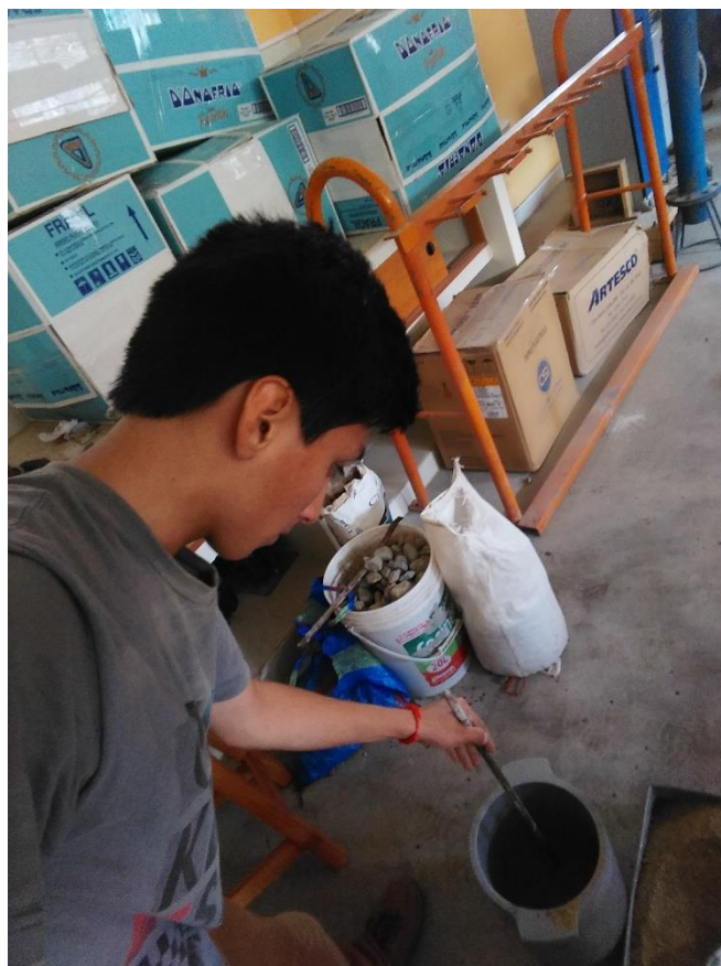
En el proceso de ensayo del peso unitario compactado del agregado fino
