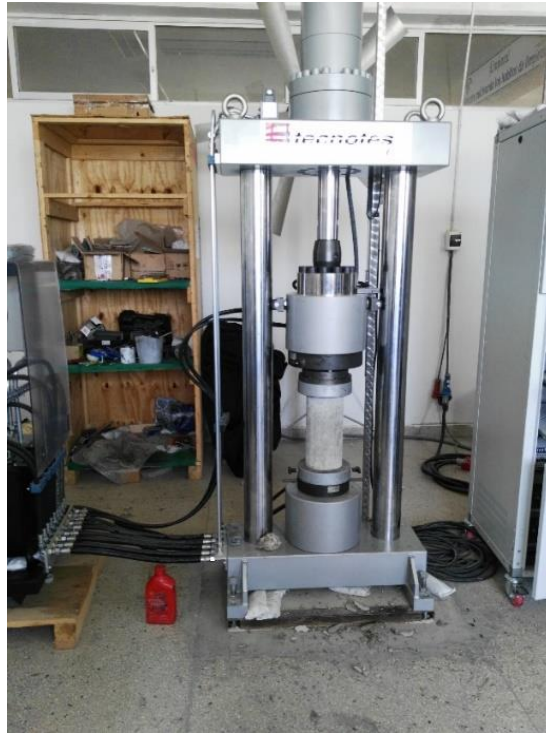
Figura 24.- Probeta ensayada en la Maquina Universal Tecnotest. Fuente: Propia
