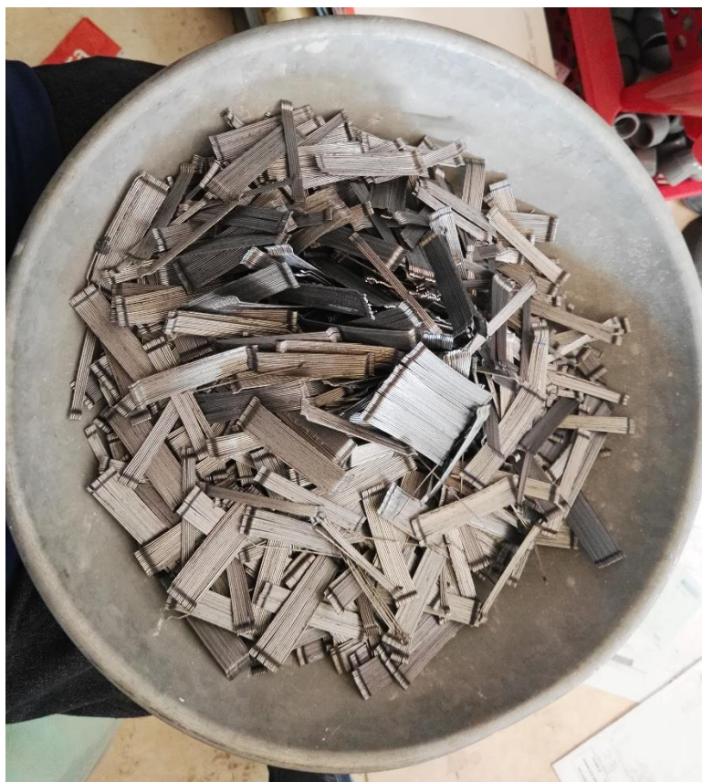
Figura 18.- Fibra de Acero ZM 80/60 utilizada en esta tesis. Fuente: Propia
