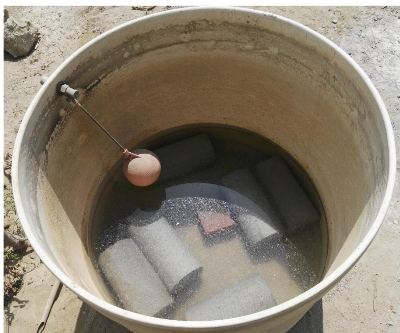
Figura 23.- Curado de las probetas de concreto. Fuente Propia
