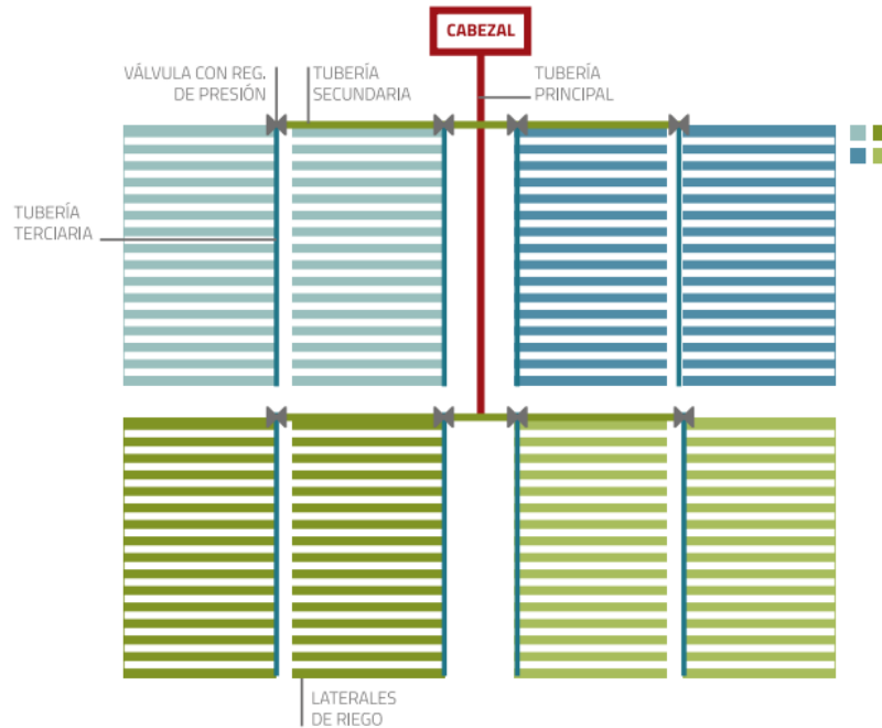
Figura 2.6. Esquema de un sistema de riego presurizado
