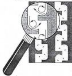
Laberinto para el autoavivado por medio de la acción del flujo turbulento y vortice del agua
