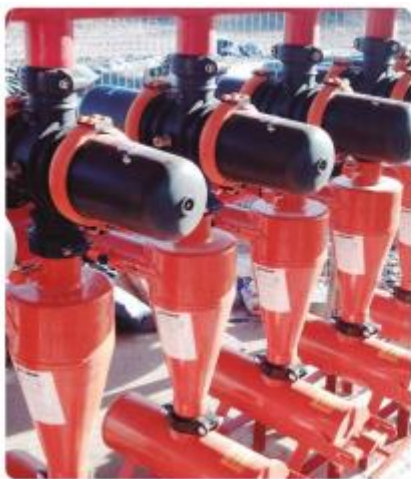
Figura 2.7. Conjunto de Hidrociclones
