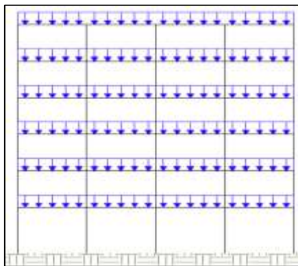
Figura 21. Cargas de gravedad de una edificación
