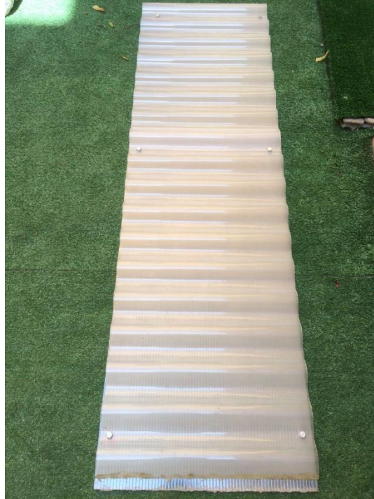
Figura N° 5-8. Empernado de la superficie de fondo ondulado
