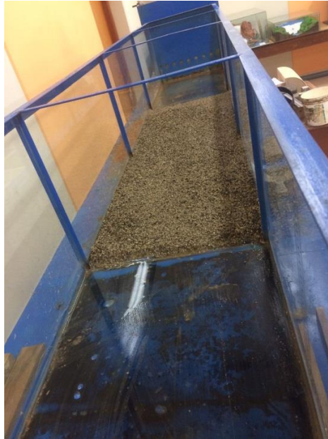
Figura N° 5-33. Superficie de Gravilla de pendiente mínima
