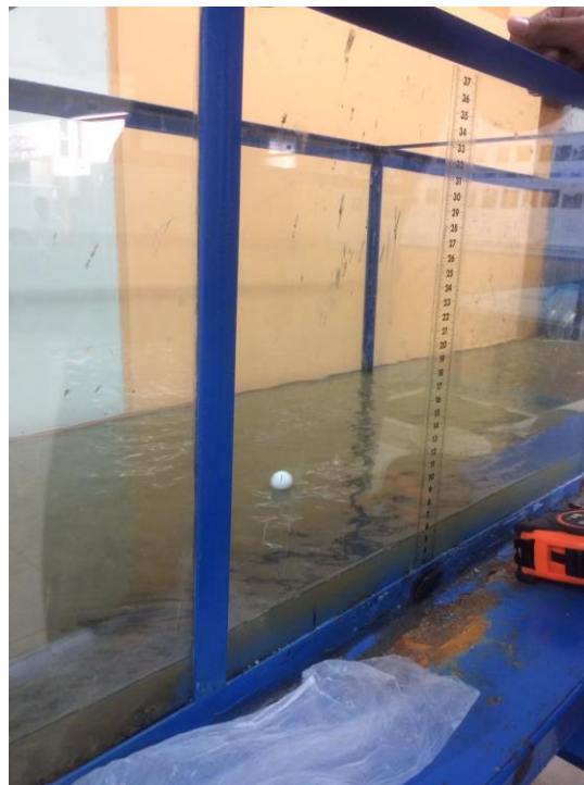
Figura N° 5-34. Pruebas de flotador en la superficie de Gravilla
