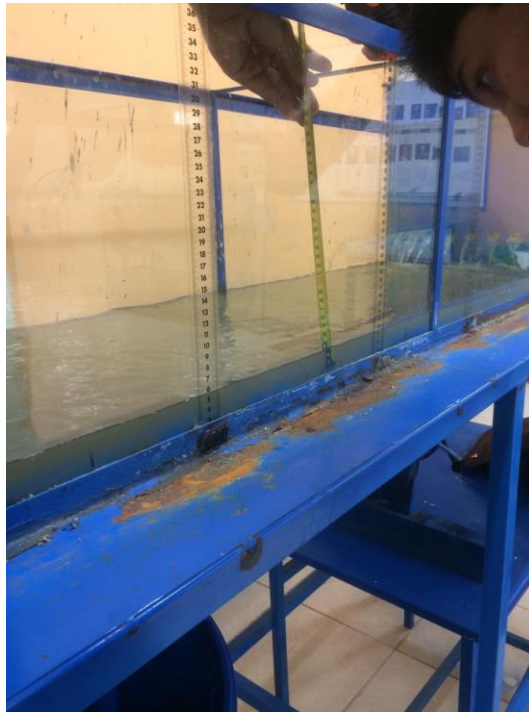
Figura N° 5-35. Medición del Tirante
