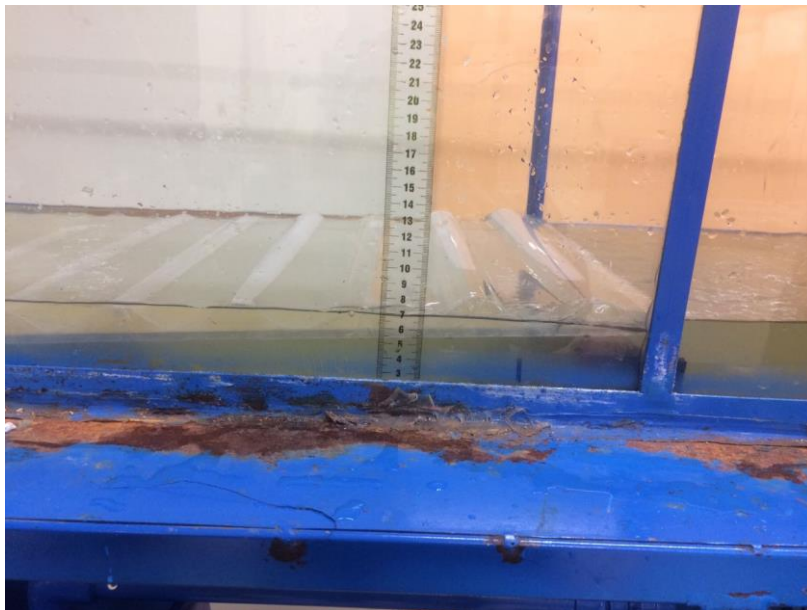
Figura N° 5-23. Superficie de fondo ondulado en pendiente de 0.0214
