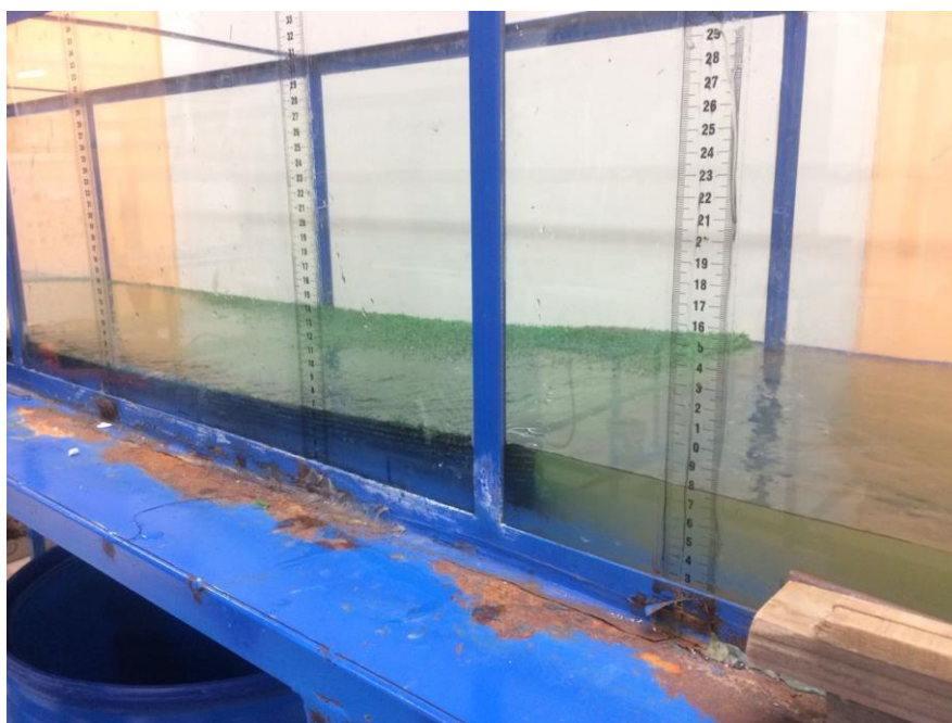
Figura N° 5-16. Superficie de grass sintético en pendiente de 0.0214
