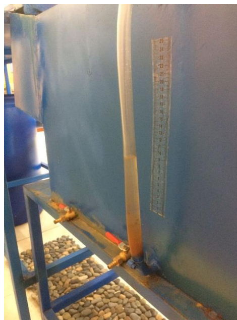
Figura N° 5-15. Nivel de agua del Vertedero
