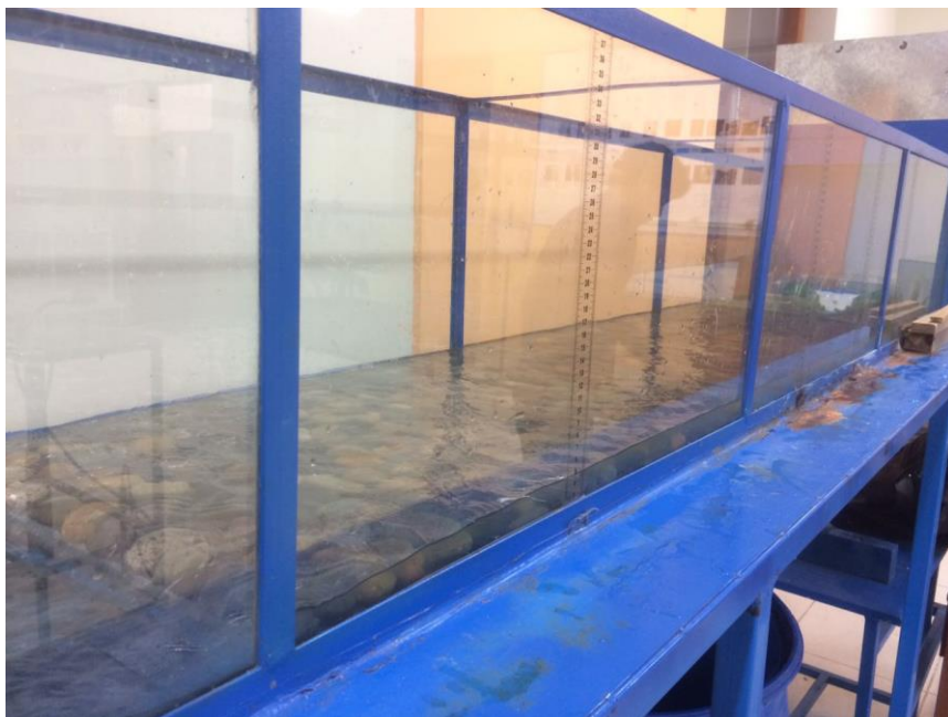
Figura N° 5-25. Colocación de la superficie de canto rodado
