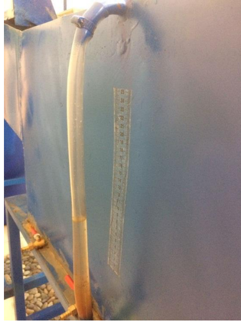
Figura N° 5-22. Nivel de agua del Vertedero
