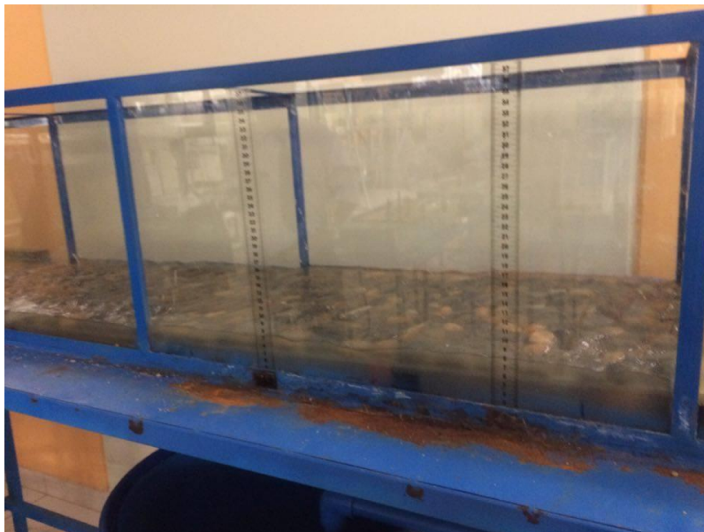
Figura N° 5-32. Superficie de canto rodado en pendiente de 0.0286
