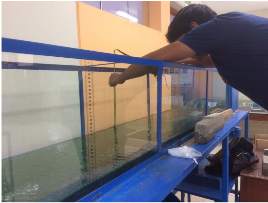
Figura N° 5-12. Medición del tirante en pendiente mínima
