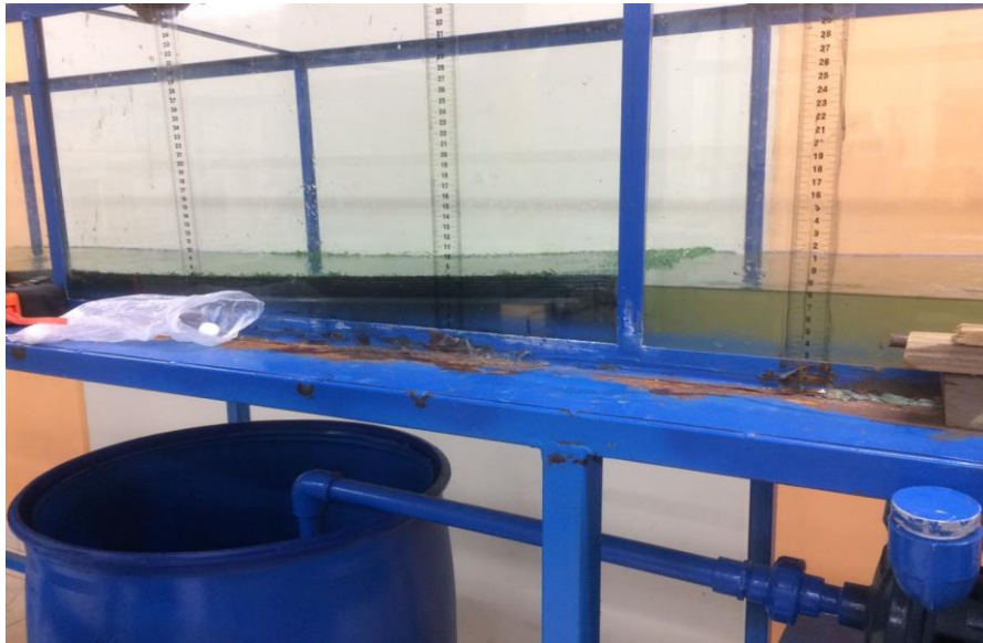
Figura N° 5-17. Superficie de grass sintético en pendiente de 0.0286
