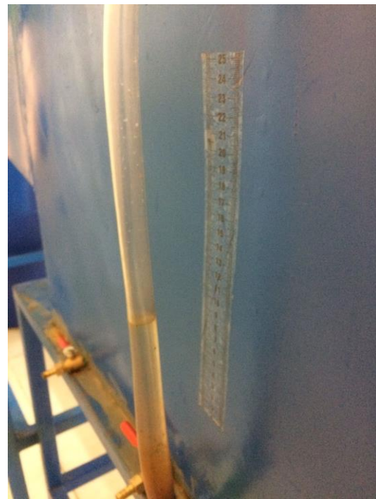
Figura N° 5-30. Nivel de agua del Vertedero
