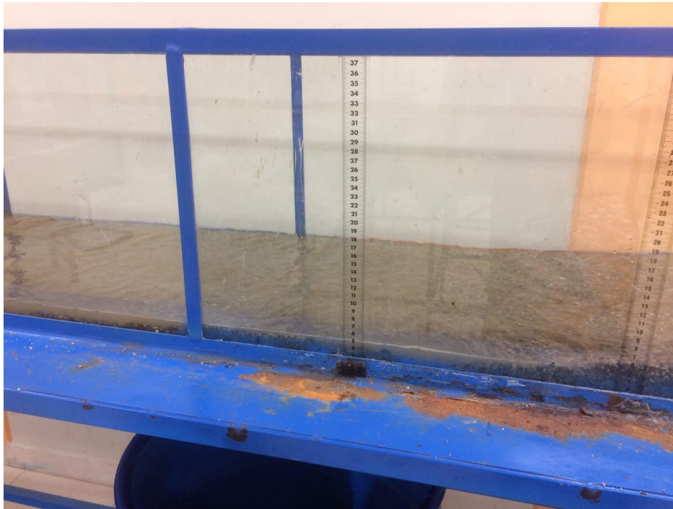
Figura N° 5-38. Superficie de Gravilla en pendiente 0.0214
