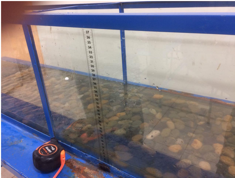
Figura N° 5-27. Cronometrando en la superficie de canto rodado
