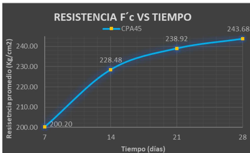
*Nota.* El gráfico muestra la tendencia de las resistencias promedios obtenidas a partir de la rotura de probetas, de las muestras de concreto más 45% de sustitución. Fuente: Elaboración propia
