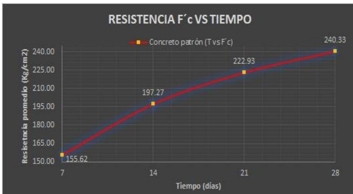
*Nota.* El gráfico muestra la tendencia de las resistencias promedios obtenidas a partir de la rotura de probetas, de las muestras de concreto patrón. Fuente: Elaboración propia.
