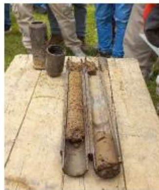
Porción de suelo obtenido con el sacamuestras del equipo SPT
