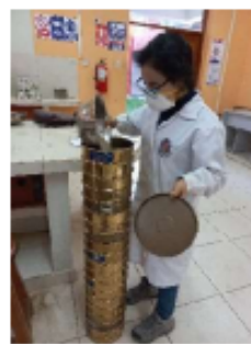
Traslado de la muestra seca a los tamices
