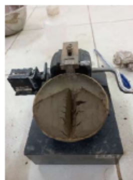
Muestra en el equipo Copa de Casagrande
