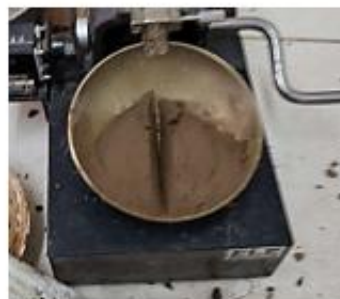
Muestra en el equipo Copa de Casagrande
