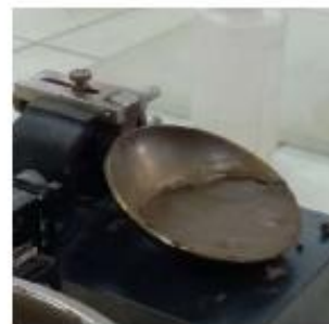
Muestra en el equipo Copa de Casagrande
