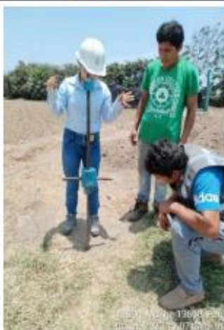
Ensayo DPL 03 en proceso
