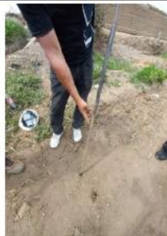
Barreta que no evidencia la presencia de Napa Freática.
