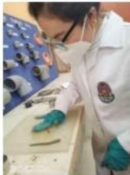
Inicio del ensayo de Plasticidad
