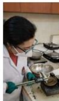
Muestra en el equipo Copa de Casagrande
