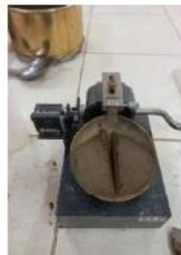
Muestra en el equipo Copa de Casagrande
