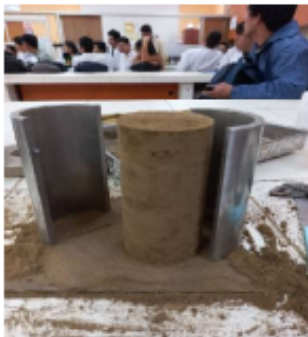
Ensayo triaxial 01 en proceso
