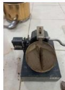
Muestra en el equipo Copa de Casagrande
