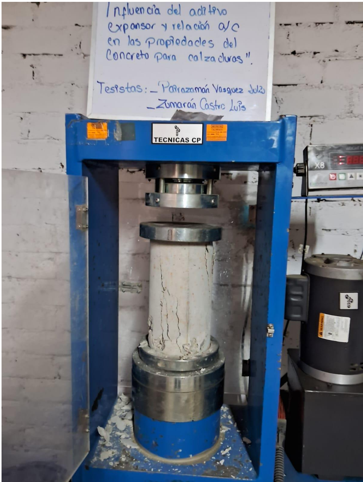
Fotografía N° 06. Ensayo de resistencia a la compresión axial
