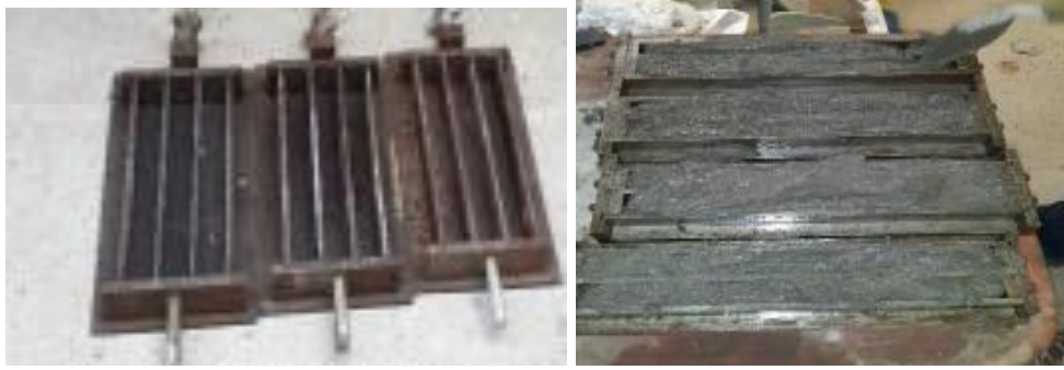
Fotografía N° 07. Elaboración de probetas para ensayo de retracción
