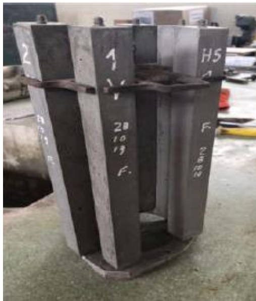
Fotografía N° 08. probetas para ensayo de retracción
