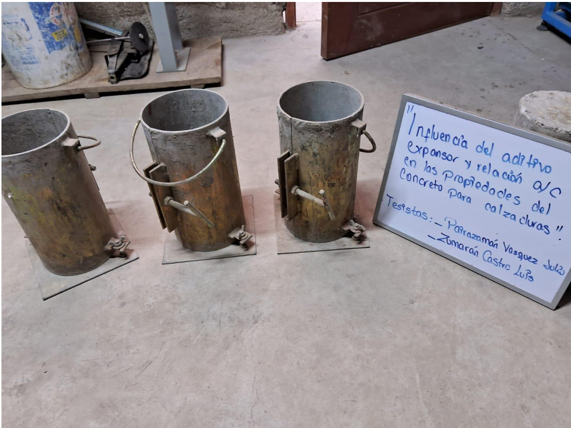
Fotografía N° 04. Moldes de para probetas cilíndricas para ensayos de compresión.
