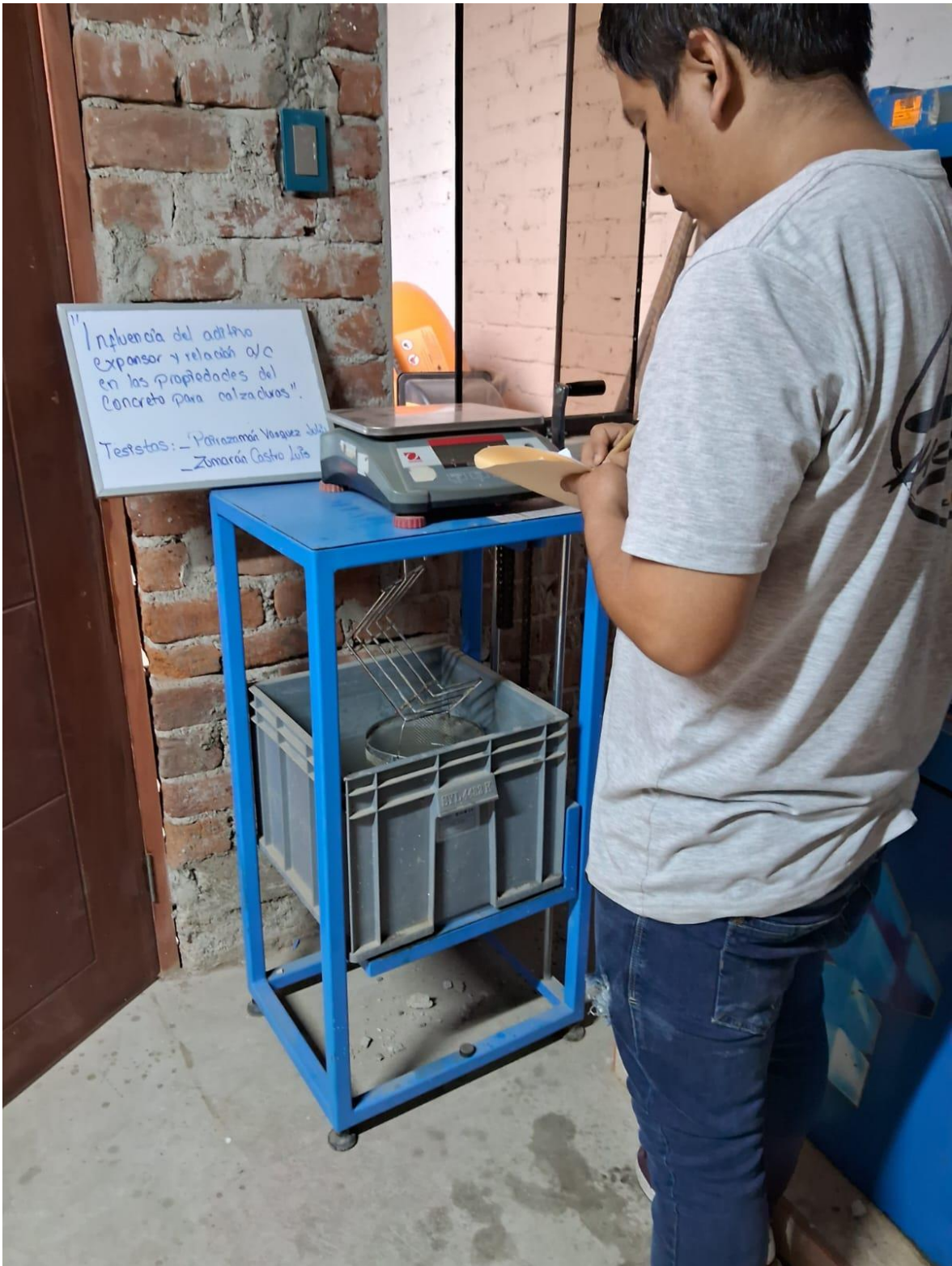
Fotografía N° 03. Densidad Aparente del agregado
