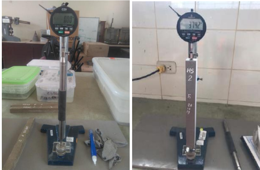
Fotografía N° 09. Equipo para medir variación de longitudes en las probetas.
