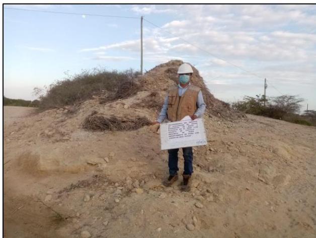
**Depósitos Aluviales antiguos:** se encuentran ubicados en pampa Calixto y las partes aledañas del dren Sechura está compuesta de cantos rodados, arenas y limos. Se observaron en las progresivas: 13+100 hasta 16+100.
