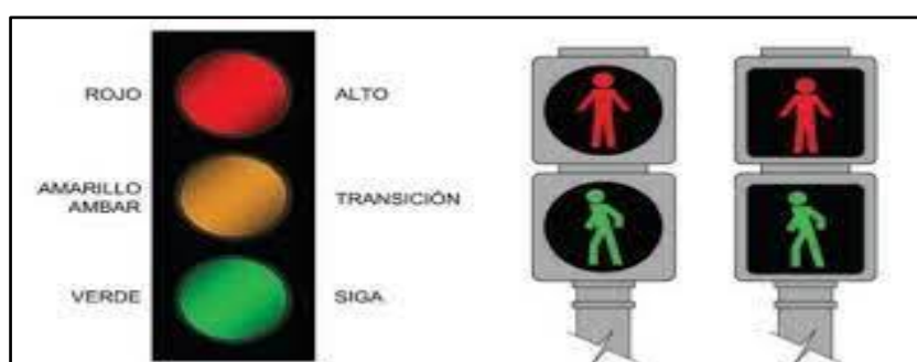
Figura 9. Luces del Semáforo - MTC
