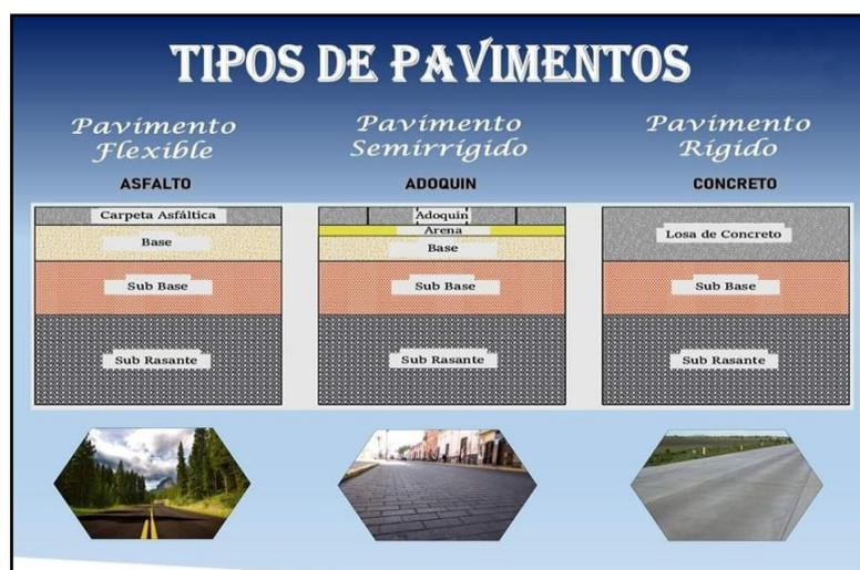
*Nota:* La imagen muestra los tipos de pavimentos que existen y como está compuesta a estructura de cada pavimento. Tomada de ESSA, 2017.
