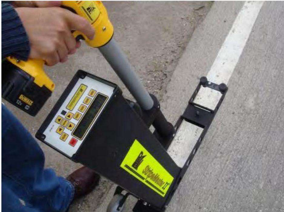
Fotografía N°08: Medición de señalización horizontal
