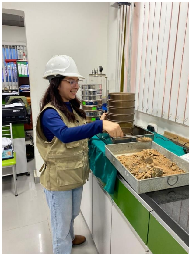
Nota: Pesado de cada la muestra retenida en cada tamiz de la Calicata C-08. Tomado del Informe de Tesis, por Asmad y Ruiz, 2024
