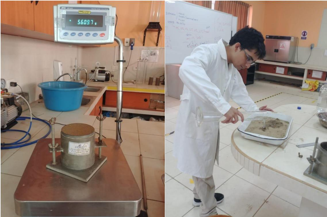
Figura 21. Ensayo de Proctor modificado con ceniza
