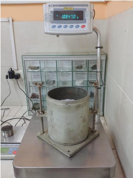
*Figura 23. Ensayo de CBR, muestras sumergidas en agua*
