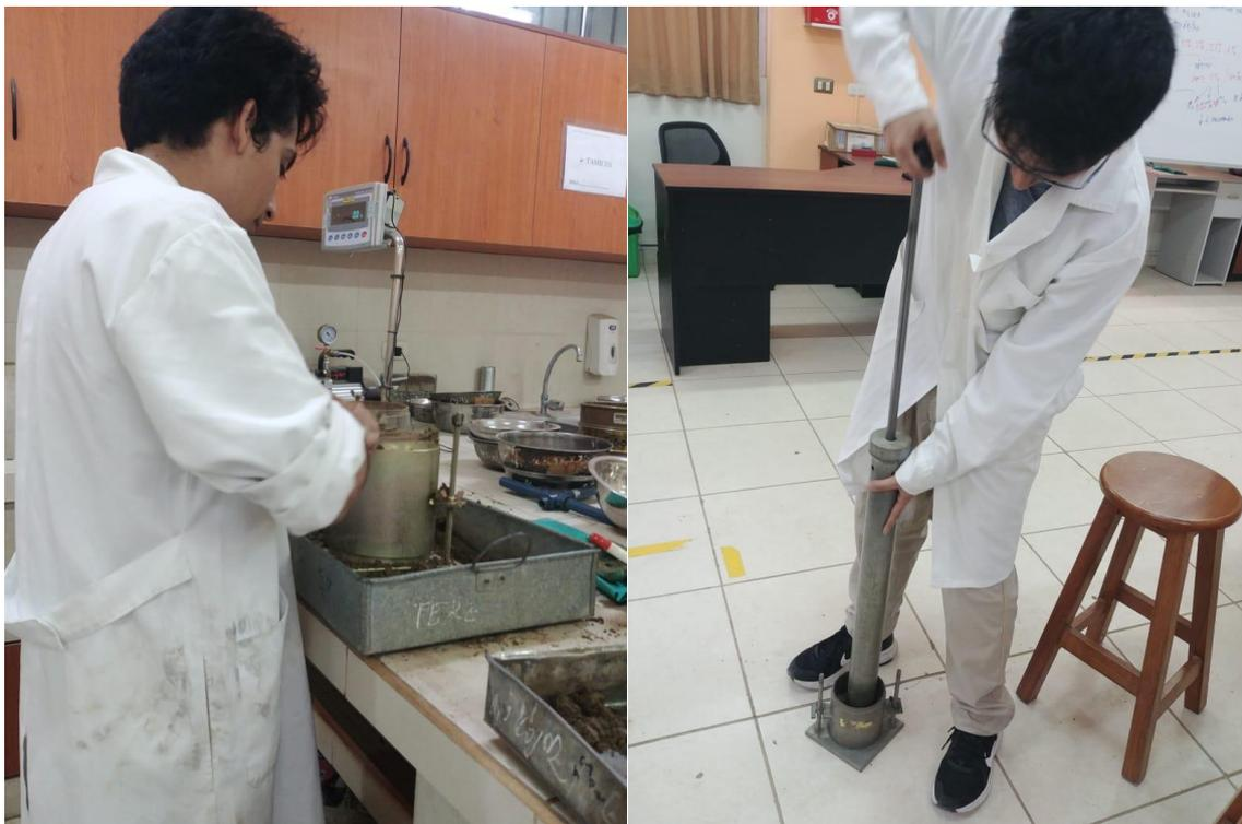
*Figura 22. Ensayo de CBR*
