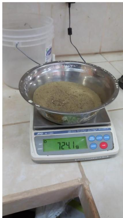
Figura 20. Ensayo de Proctor modificado
