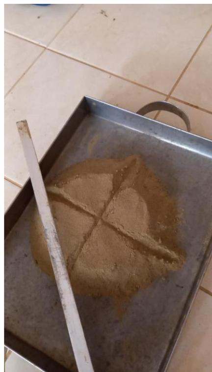
Figura 18. Tamizado de las muestras recolectadas (Ensayo de Granulometría)
