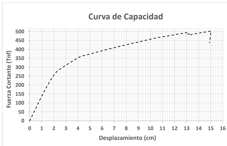
Figura 57. Curva de capacidad en dirección X
