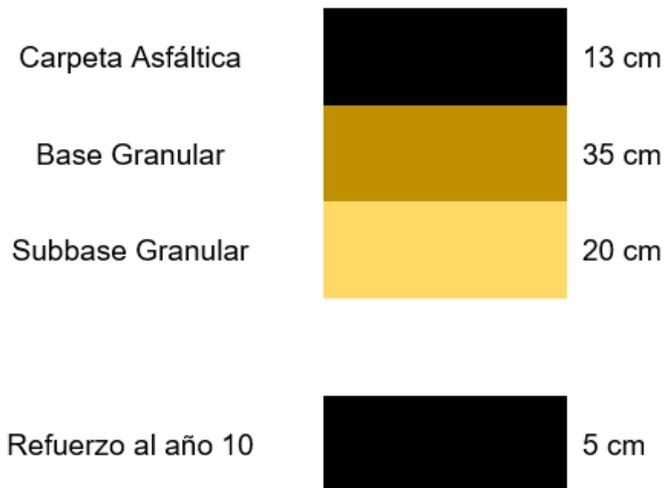
*Nota.* Esta imagen muestra los espesores de capa que se obtuvieron en el diseño de bases y capa asfáltica, elaborado por Hidalgo y Pintado, 2023.
