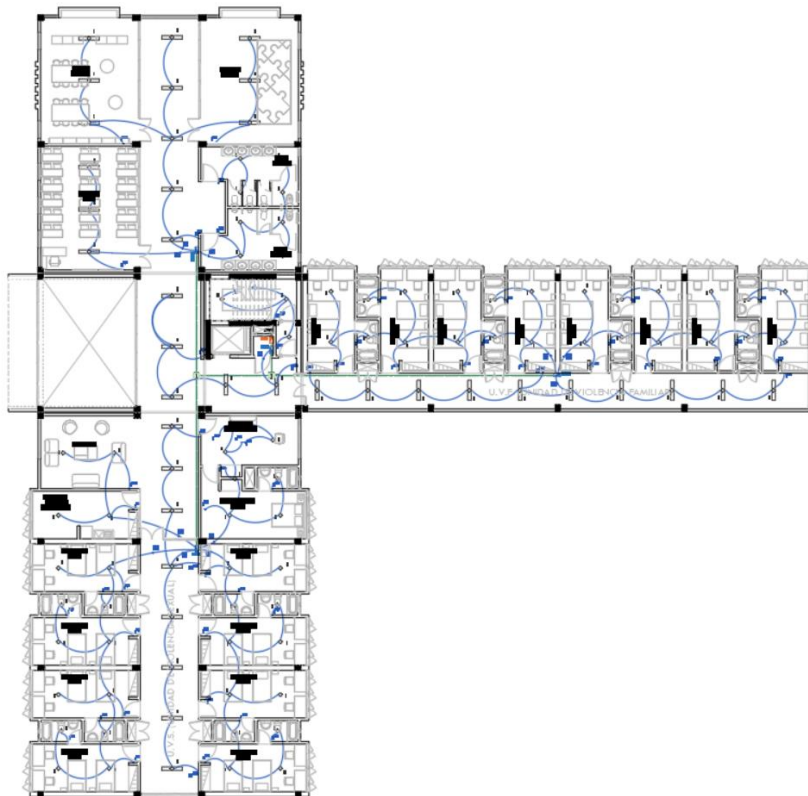
Figura N° 130: Distribución de iluminación Nivel 5
