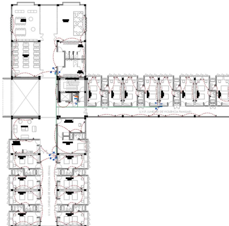
Figura N° 136: Distribución de tomacorrientes Nivel 5
