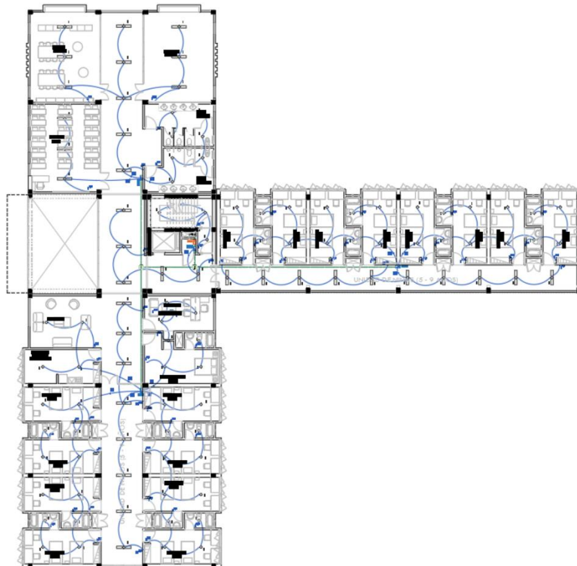
Figura N° 128: Distribución de iluminación Nivel 3
