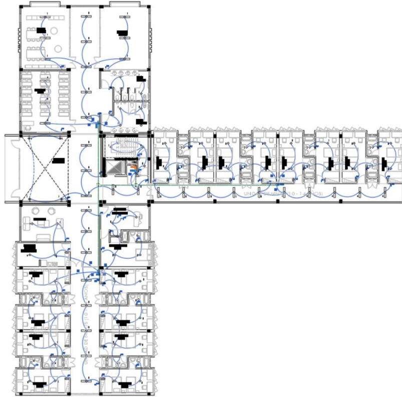
Figura N° 129: Distribución de iluminación Nivel 4
