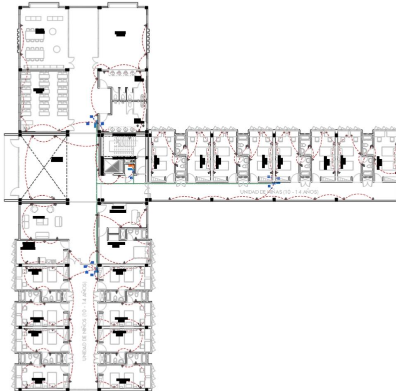
Figura N° 135: Distribución de tomacorrientes Nivel 4
