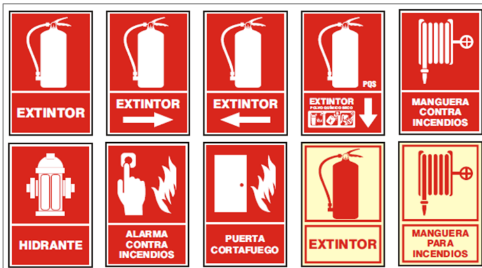
Figura 88 Señalización de equipos de prevención y protección contra incendios.
