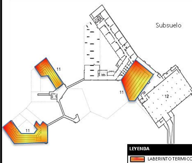
Figura**: Vista en planta del sistema de calefacción del suelo del colegio Alemán de Madrid Fuente:Detail documentation y propia.
