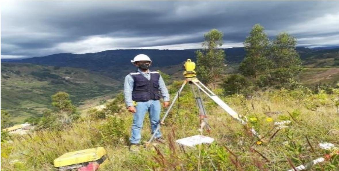
*Nota:* La figura muestra que se realizó el levantamiento topográfico en el tramo inicial del Camino Vecinal, progresiva 7+600.00 por medio de una Estación Total.
