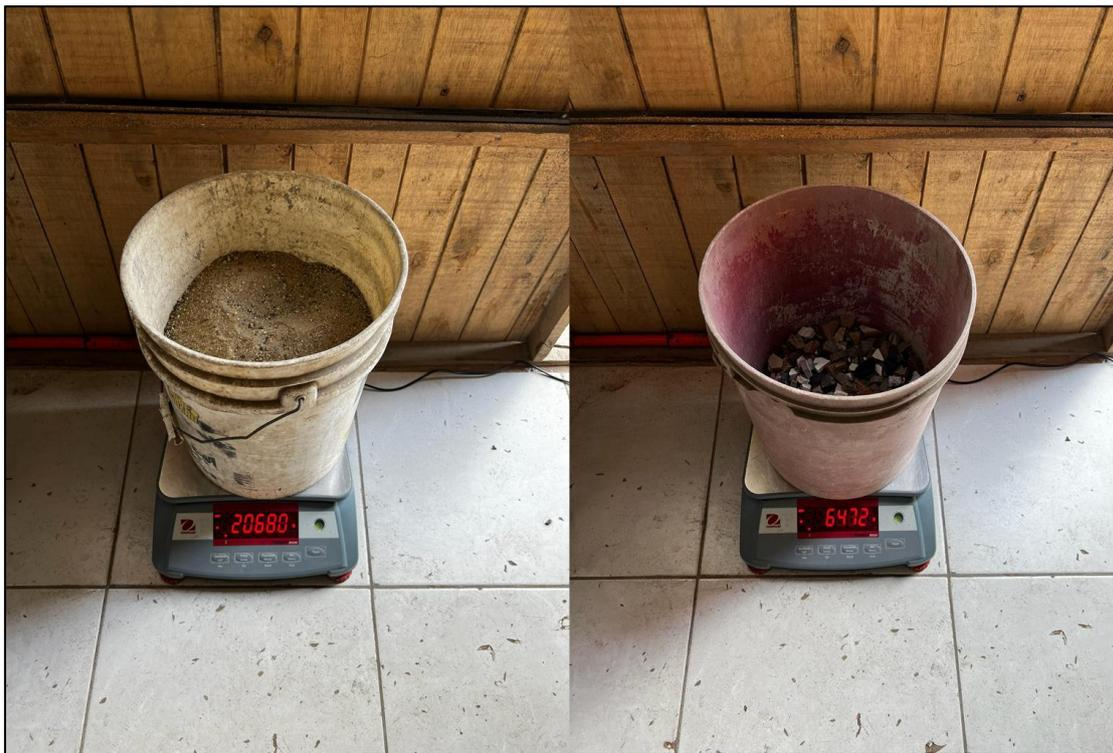
Nota: Peso de cemento y residuos cerámicos para la mezcla de concreto.
