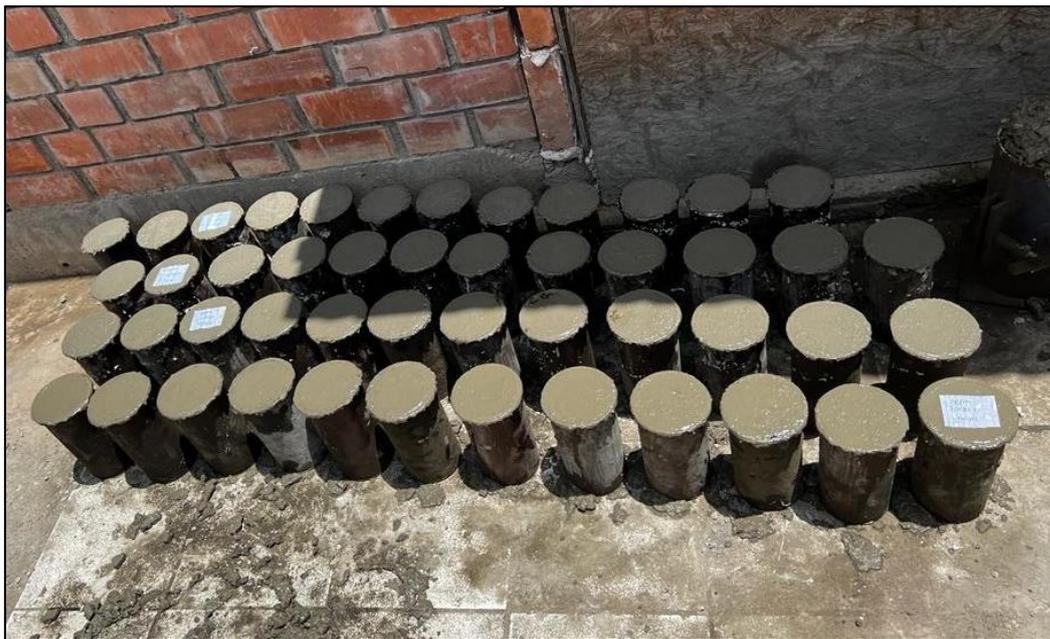
Nota: Los 48 testigos cilíndricos elaborados con los 4 tipos de mezcla para su posterior ensayo a la resistencia a la compresión.
