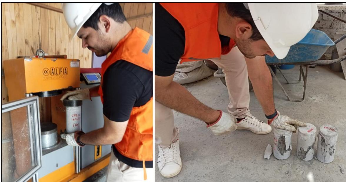
Nota: Ensayo de rotura para la resistencia a la compresión de los testigos cilíndricos de concreto.
