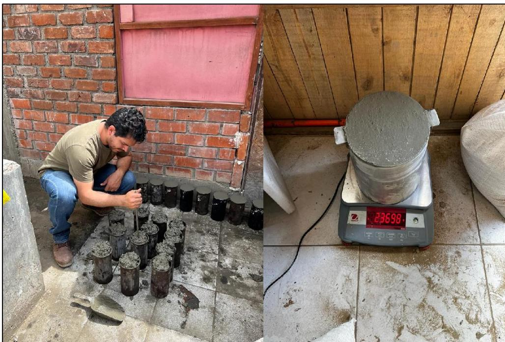
Nota: Elaboración de los testigos cilíndricos de concreto (probetas) para el posterior ensayo de resistencia a la compresión.
