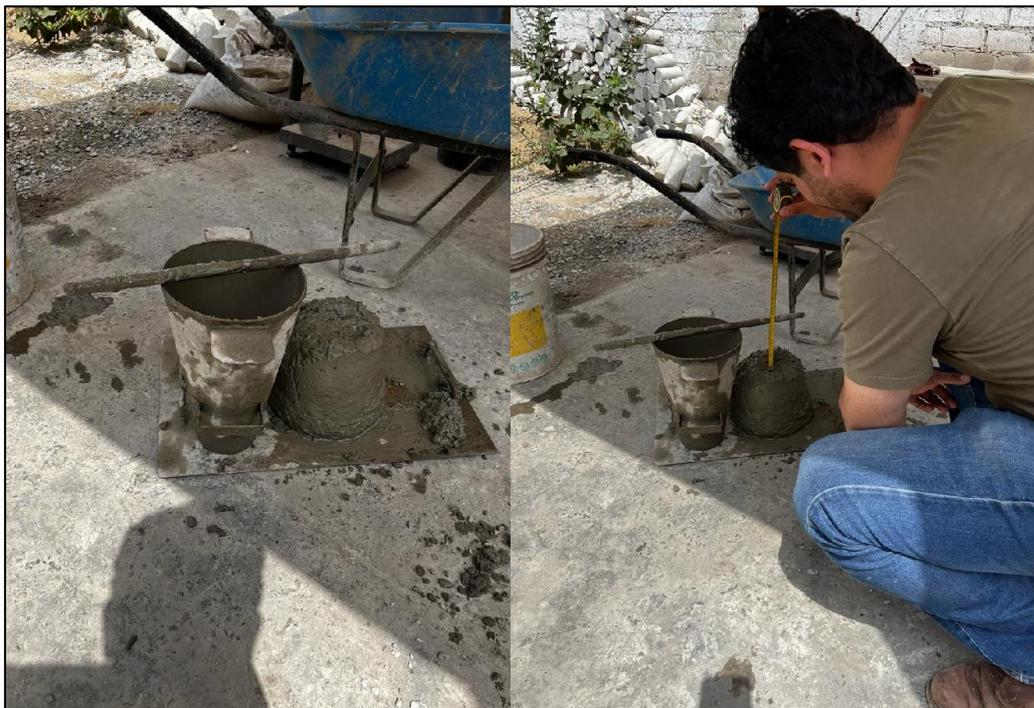
Nota: Ensayo de asentamiento del concreto, el cual se realiza en estado líquido.
