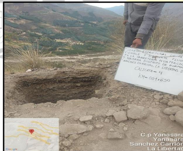
Fotografía N°04: Excavación de Calicata 04.
