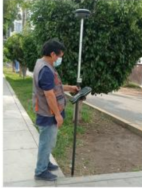
FIG 09: Levantamiento planimétrico y altimétrico de los parques.
