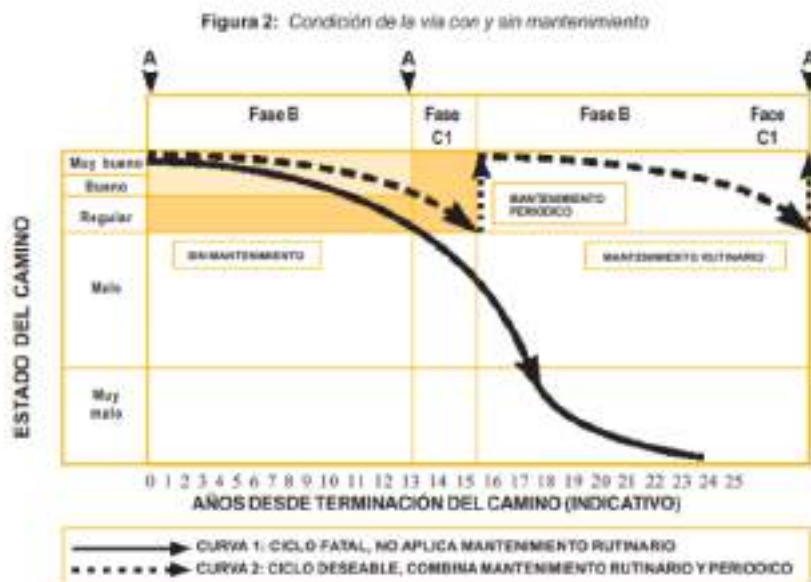
Figura 2. Condición de la vía con y si mantenimiento
