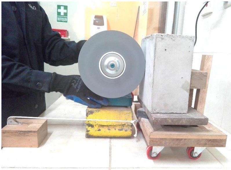
Anexo 15. *Ensayos previos para comprobar que el plano de muestra quedó ubicado tangencialmente al plano del disco abrasivo.*
