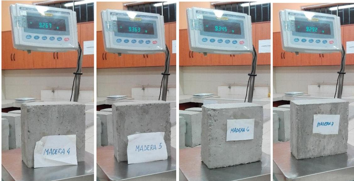
Anexo 24. Muestras de madera de  $f'c=210\text{kg/cm}^2$  después de ser sometidas al ensayo.
