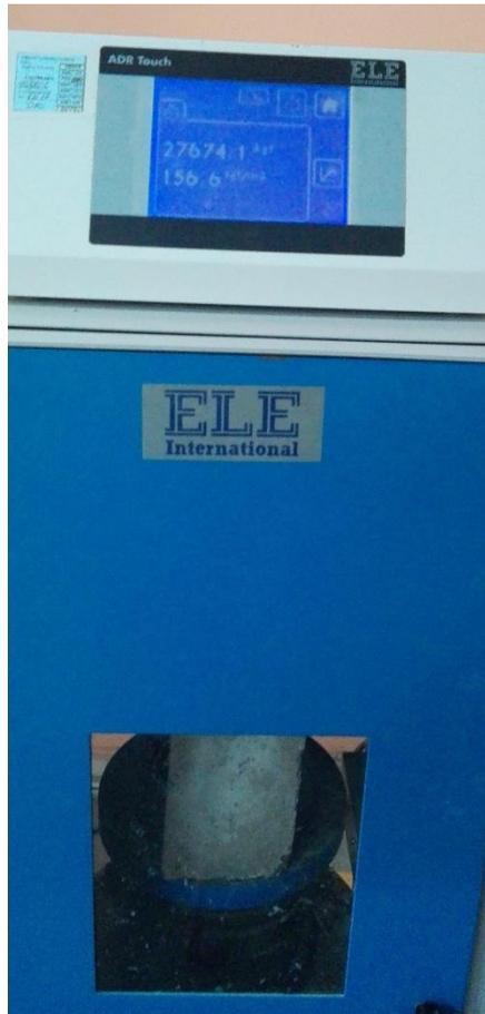
Anexo 9. Se somete la muestra a prueba de compresión.
