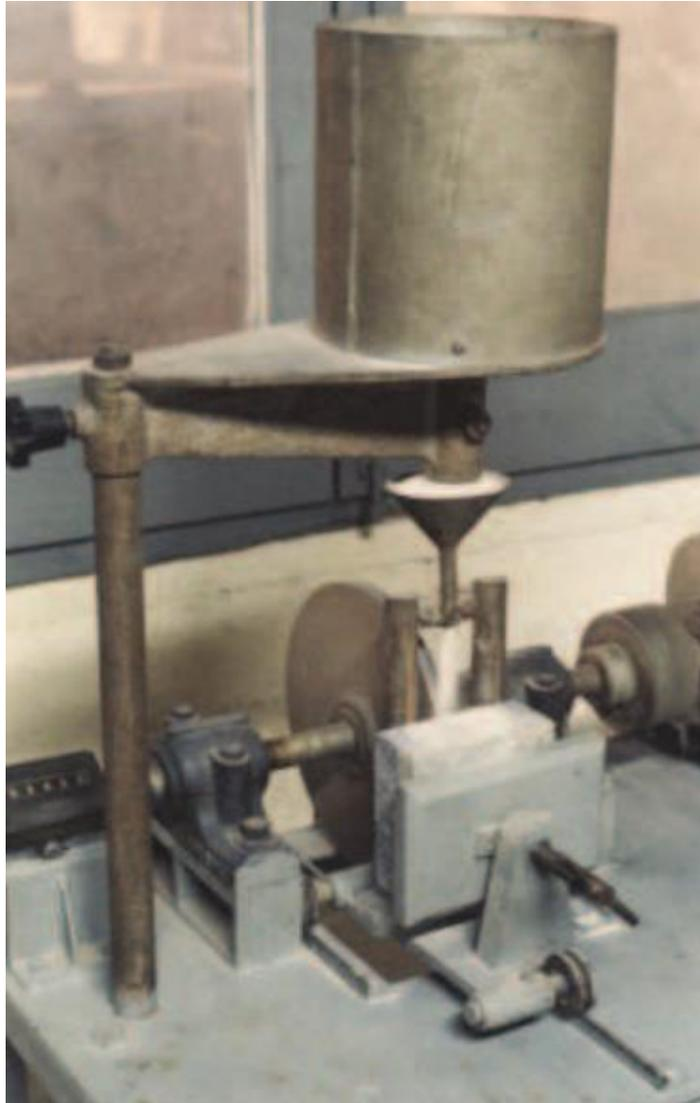
Figura 6. *Ensayo de desgaste según NTG 41087.*
