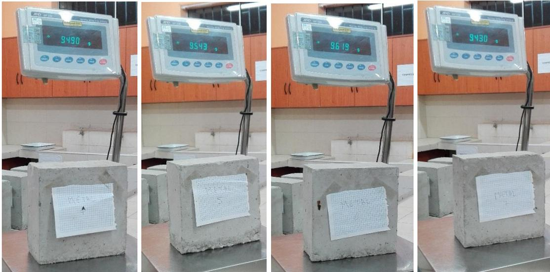
Anexo 23. Muestras de metal de  $f'c=175\text{kg/cm}^2$  después de ser sometidas al ensayo.
