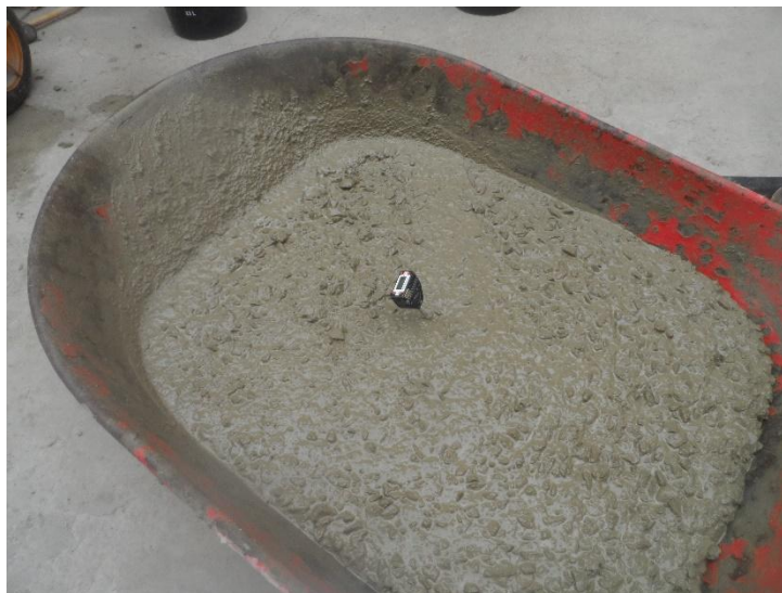
Figura N°. 27. Medida de Temperatura del concreto.
