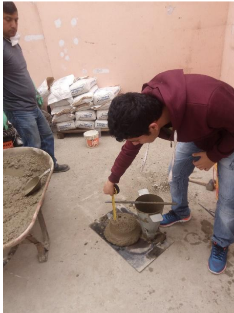
Figura N°. 26. Medida del asentamiento del concreto.
