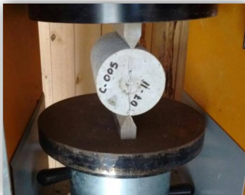
Figura N°. 43. Ensayo de compresión diametral.
