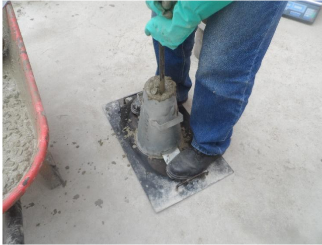
Figura N°. 25. Compactación, con varilla punta de bala.
