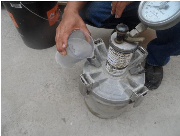
Figura N°. 31 y 32. Olla de Washington agregado de agua y bombeo de aire.
