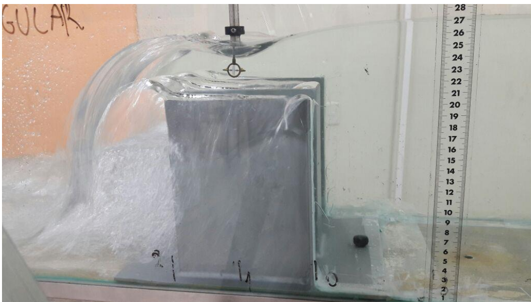
FOTOGRAFÍA Nº 02: MEDICIÓN DE VELOCIDADES CON EQUIPO DIGITAL DEL CANAL DE PENDIENTE VARIABLE.
