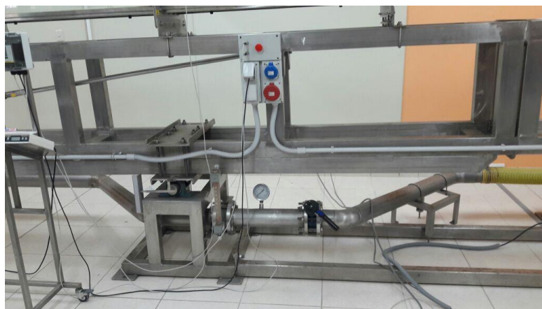
Fotografía 02.- Rotámetro y válvula de regulación de caudal. (UPAO)
