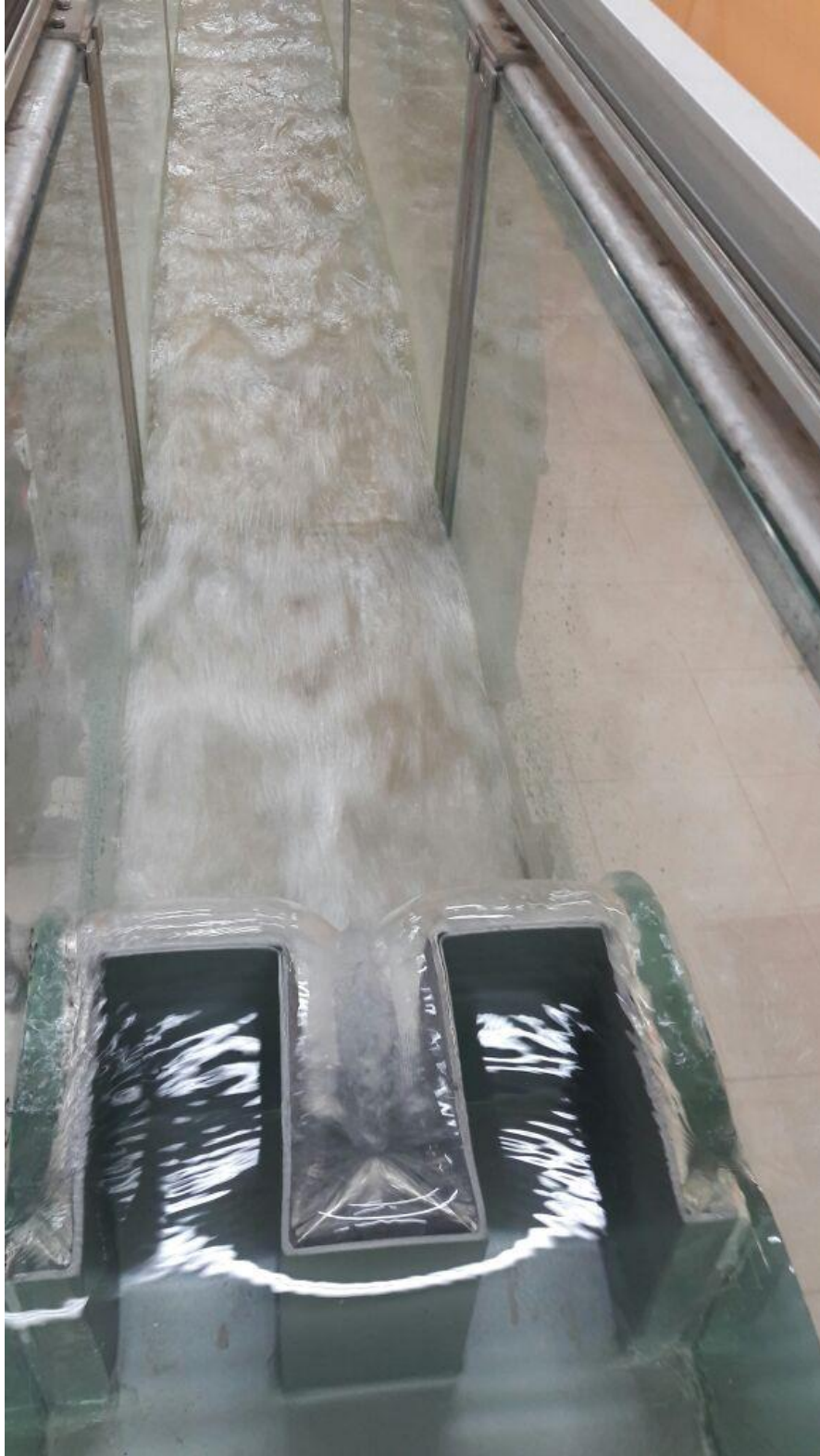
FOTOGRAFÍA Nº 07: COMPORTAMIENTO DE FLUJO EN VERTEDERO TIPO LABERINTO RECTANGULAR CON PENDIENTE 2%.
