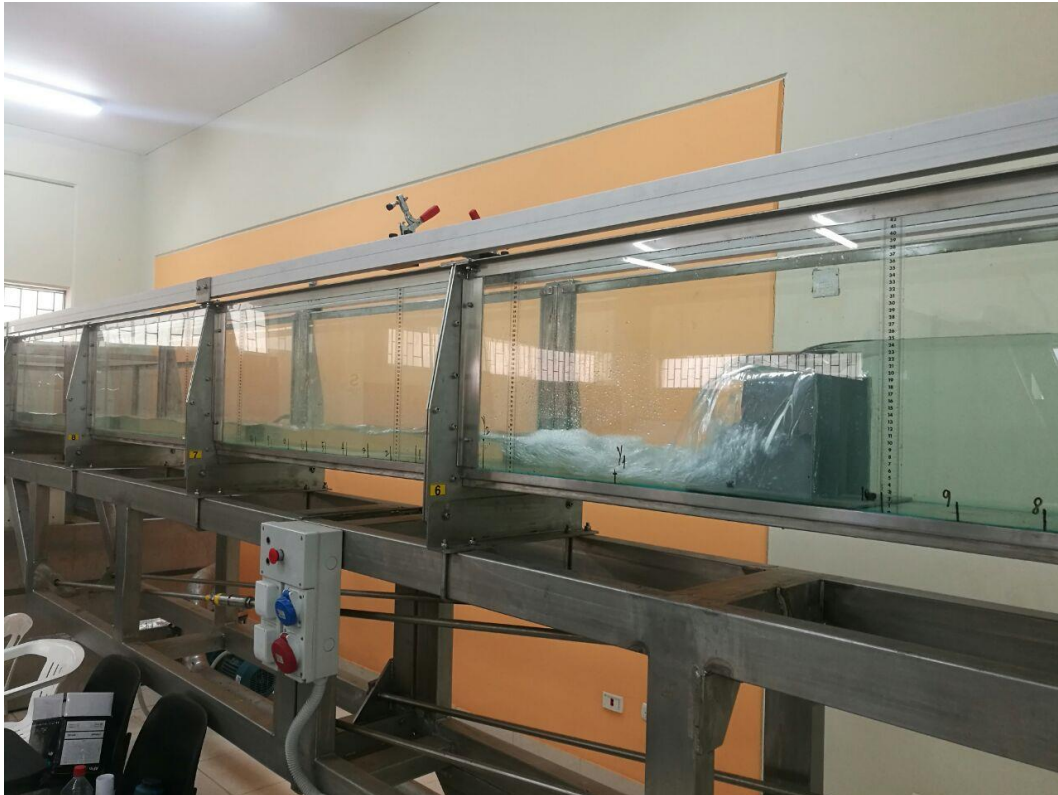
FOTOGRAFÍA Nº 01: PERFIL DE CANAL PENDIENTE VARIABLE PARA TOMA DE DATOS.
