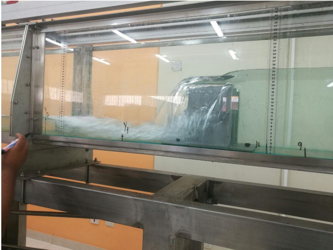
FOTOGRAFÍA N° 08: FORMACIÓN DE RESALTO HIDRÁULICO EN VERTEDERO LABERINTO TRAPEZOIDAL.
