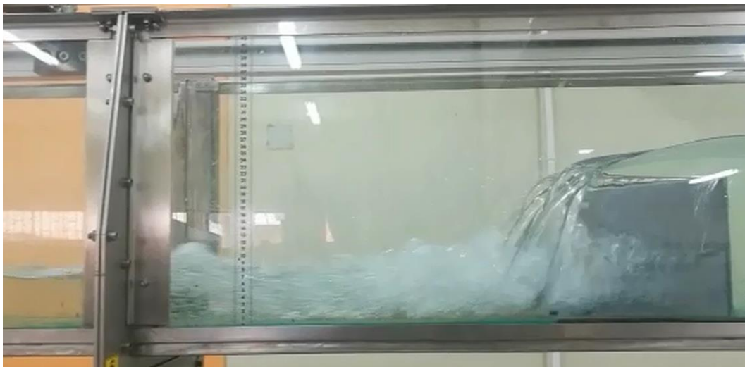
FOTOGRAFÍA N° 04: FORMACIÓN DE RESALTO HIDRÁULICO EN VERTEDERO LABERINTO TRIANGULAR.
