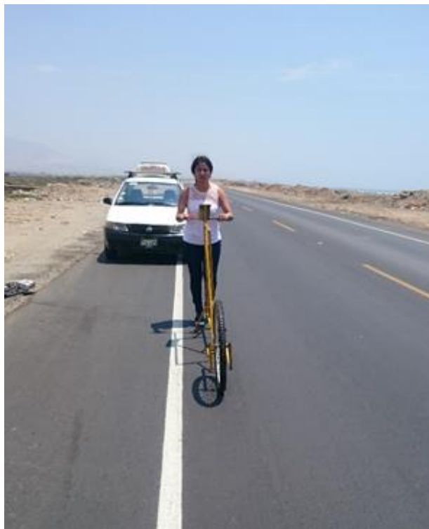
Foto: Obtenemos los datos para el ensayo del Método de Merlín en el km. 576+080.
