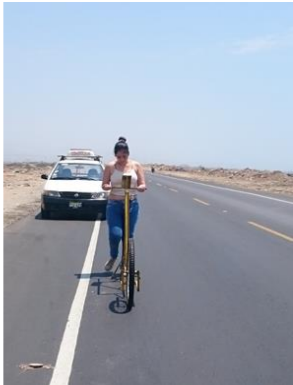
Foto: Realizamos la toma de datos para el ensayo del Método de Merlín en el km. 573+120.
