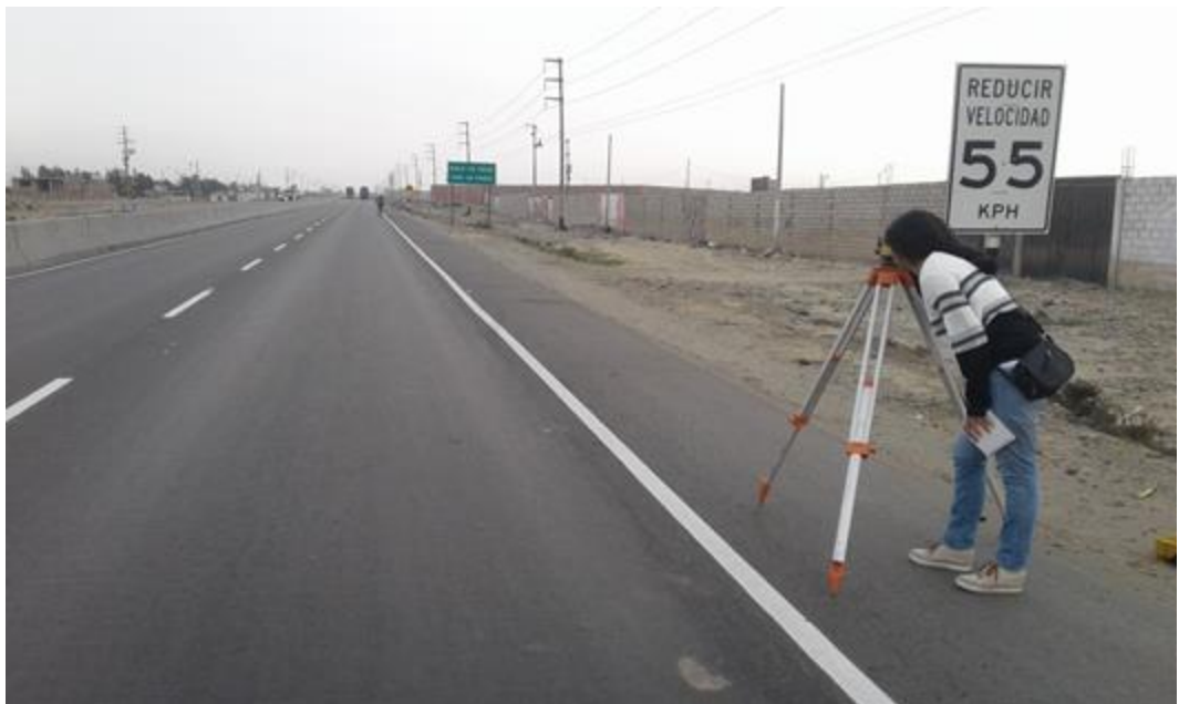
Foto: Obtenemos los datos para el ensayo Road and Level en el km. 580+370.
