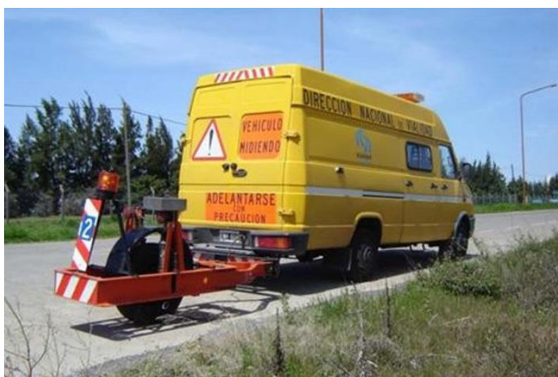
Figura N° 02. El Analizador de Perfiles Longitudinales (APL)
