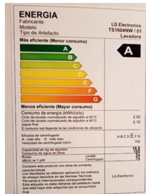
Figura 20. Especificaciones técnicas de lavadora en domicilio.
